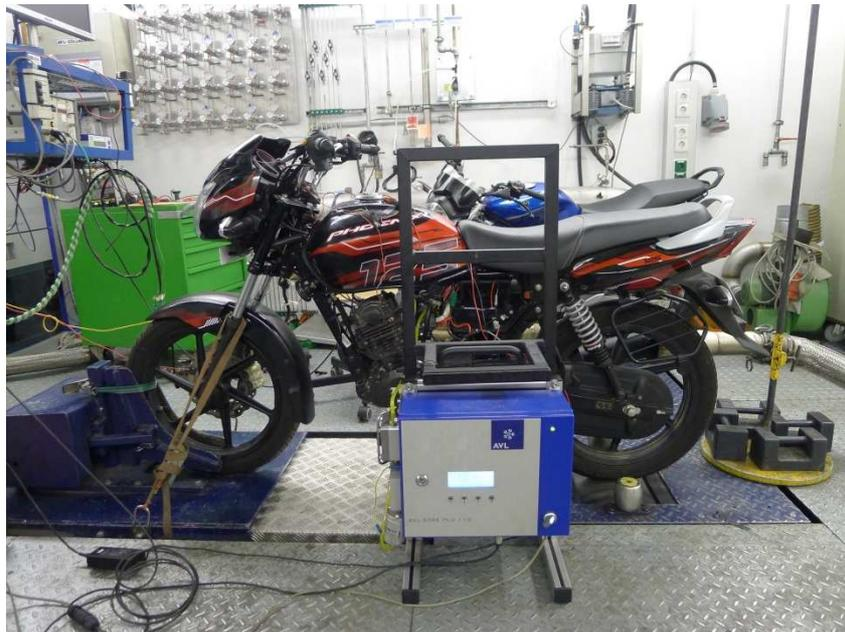
Abbildung 5-3: Aufspannung der TVS-Phoenix auf der Zweiradrolle
