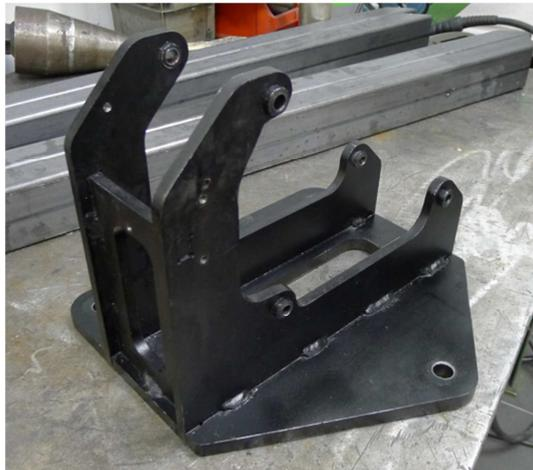
Abbildung 4-9: Motorgestell für den Motorprüfstand
