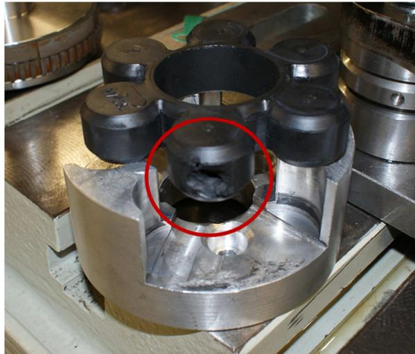
Abbildung 4-7: aufgeplatztes Dämpfungselement der Klauenkupplung
