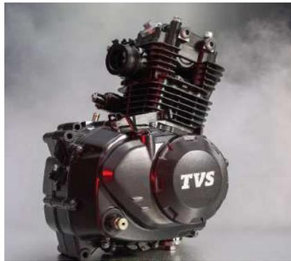
Abbildung 3-3: TVS Phoenix Motor mit einem Hubraum von 125cm<sup>3</sup>
