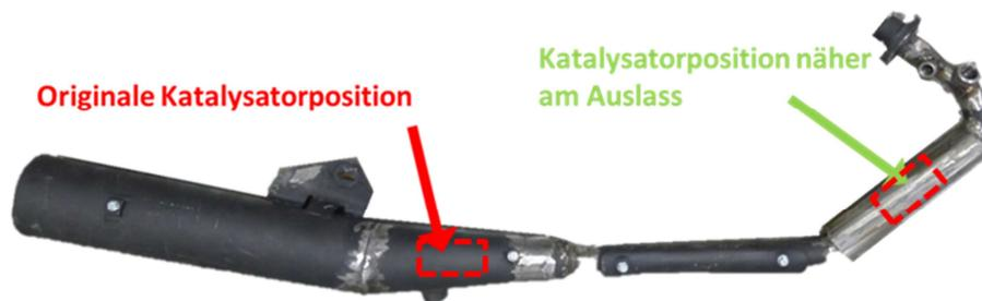
Abbildung 5-19: Katalysatorposition näher am Auslass (R5)
