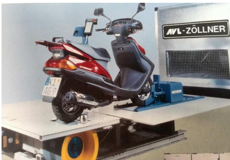
Abbildung 5-1: AVL-Zöllner 2-Rad-Rollenprüfstand
