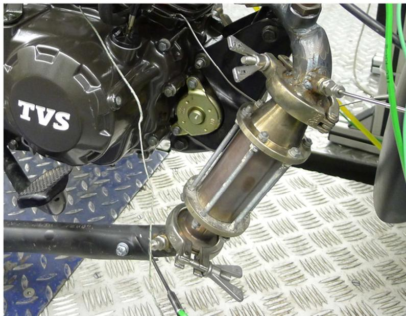
Abbildung 5-21: Schnellwechselsystem Katalysator (R6)
