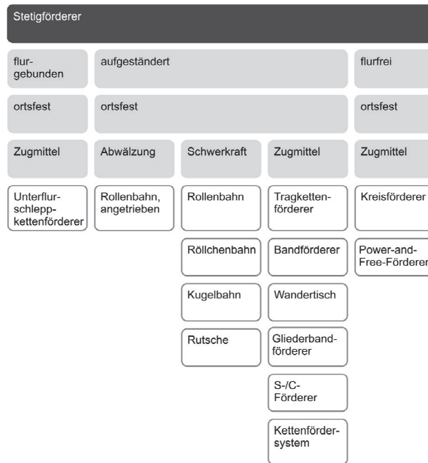
Abbildung 2-5: Systematik der Stetigförderer für Stückgutförderung [HSN+07, S. 124]
