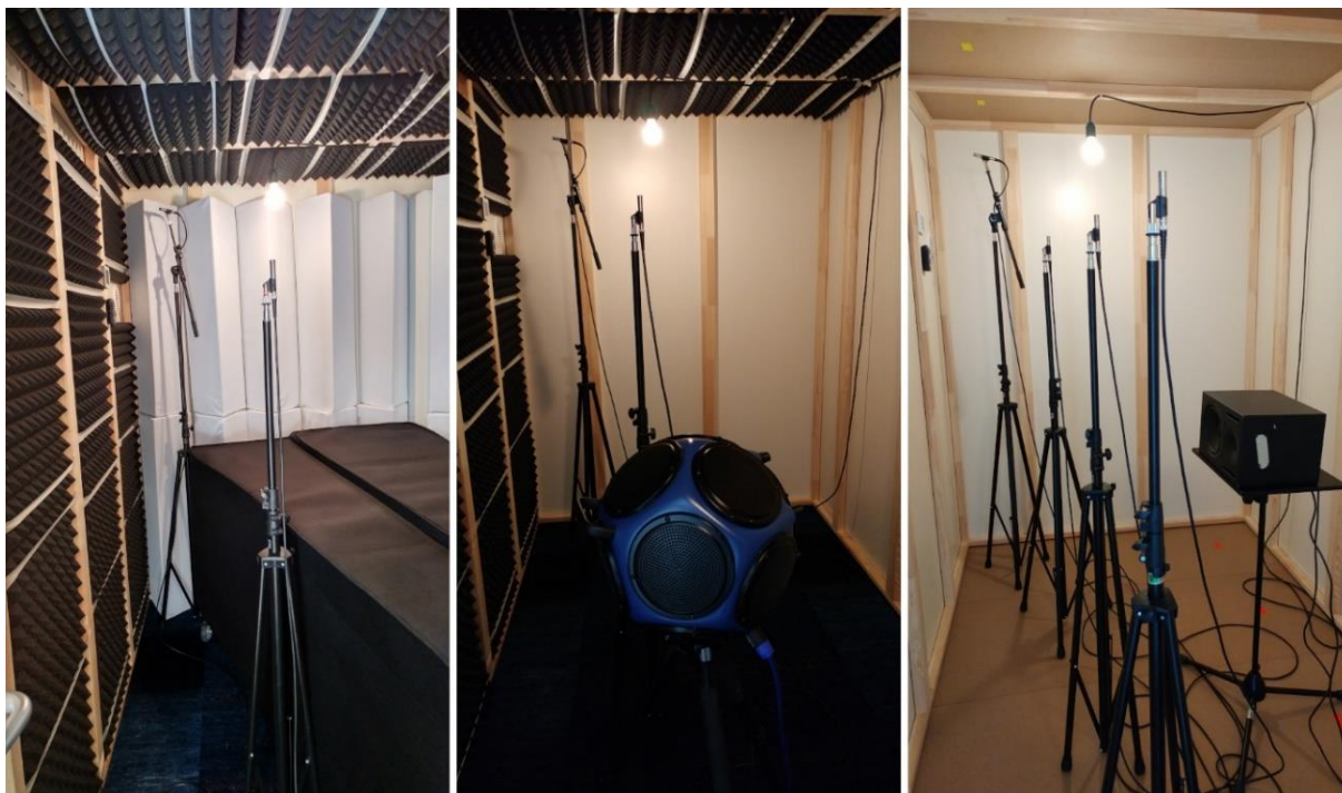
Abb. 4.6: Messsituation Übekabine zu den Raumausstattungs Zuständen (1)a [links], (2) [mittig] und (3) [rechts]
