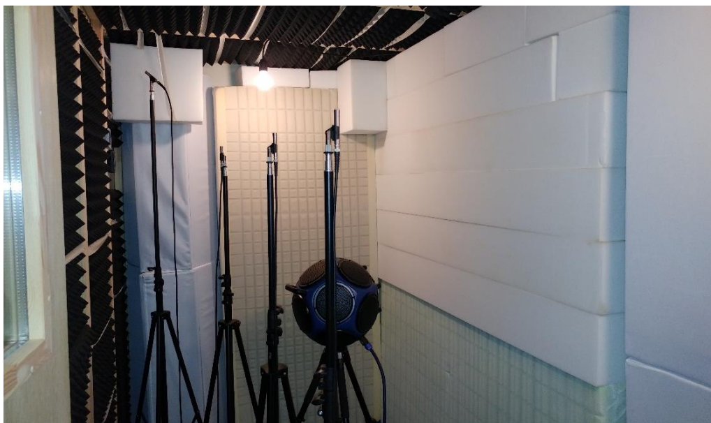
Abb. 6.6: Messsituation in der Übekabine zum Raumausstattungs Zustand (4)
