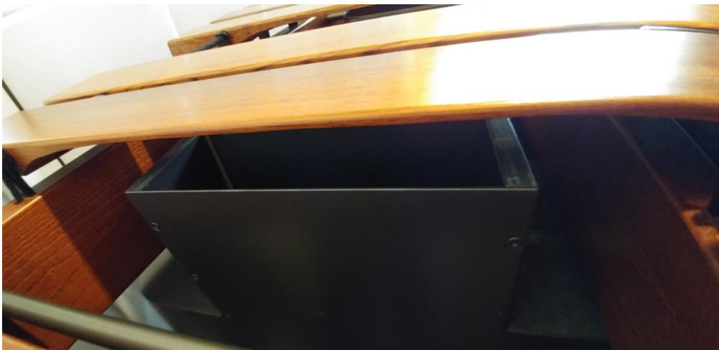
Abb. 2.1: Klangstab mit zugehörigem Helmholtz-Resonator (C#)
