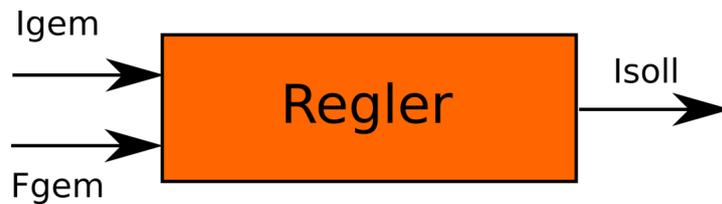
Abbildung 26:  $I_{gem}$  ist der gemessene Strom durch den Gleichstrommotor an System 1.  $I_{soll}$  ist der Soll-Strom, also die Stellgröße um das notwendige Drehmoment  $M_1$  zu erzeugen
