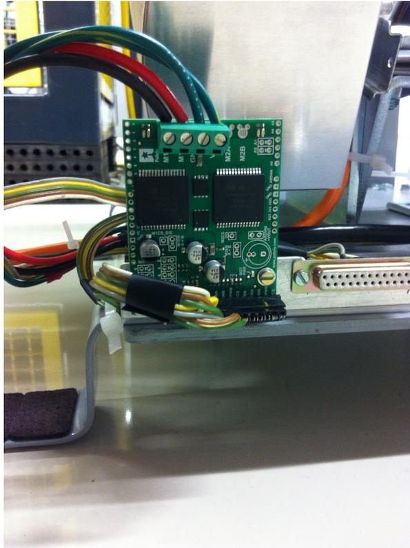
Abbildung 16: Abbildung der Motortreiberplatine VNH5019
