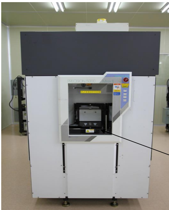
Abbildung 4.11 1: Ansicht der Front einer P5000. In der Mitte sieht man die Ladekammer
