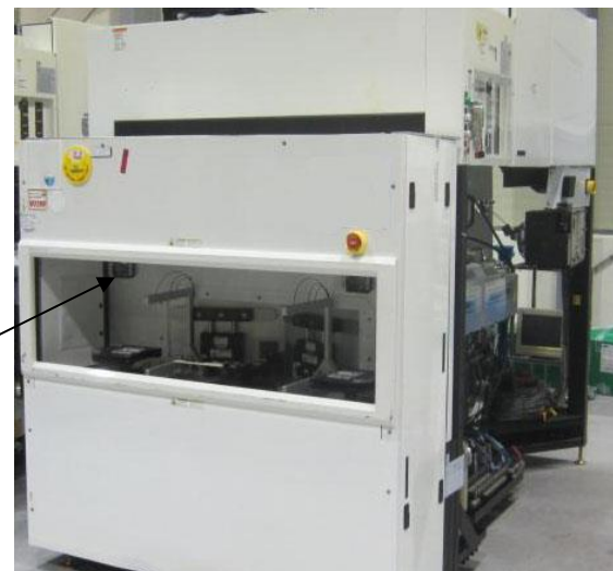
Abbildung 4.13 2 : Frontansicht der Producer. Zu sehen ist die Ladekammer mit den beiden Plätzen für je eine Kassette und den schwarzen Klappen der Loadlock Chambers.
