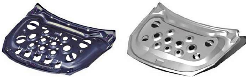
Abbildung 3.26: Vergleich eines detaillierten Strukturmodelles links (rund 800 Flächenoperationen) und vereinfachten Konzeptmodell rechts (95 Flächenoperationen)
