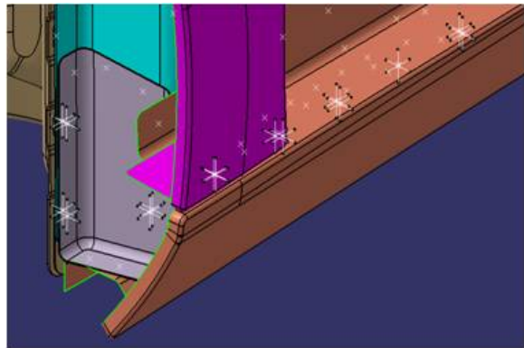
Abbildung 3.32: Visualisierung von nicht eindeutig zugeordneter Verbindungstechnik
