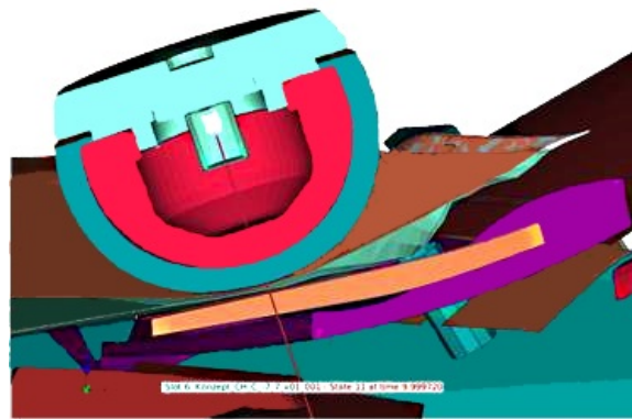
Abbildung 3.17: Simulationsmodell zur Analyse der Beschleunigung beim Kopfaufprall auf eine Frontklappe in Y0-Ansicht (Quelle: MAGNA STEYR Engineering AG & Co KG)
