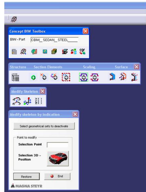
Abbildung A.6: Programmerweiterung für den konzeptionellen Rohbau
