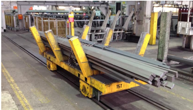
Abbildung 3-51: Transport mittels Querverschiebewagen
