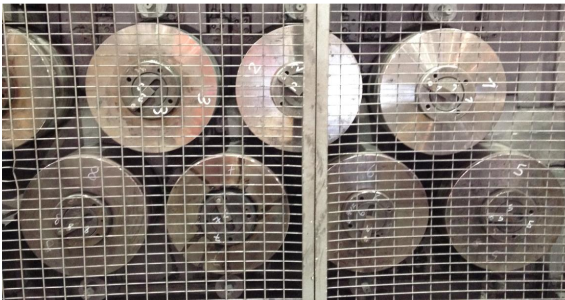
Abbildung 3-16: Umformeinheit einer Rollenrichtmaschine
