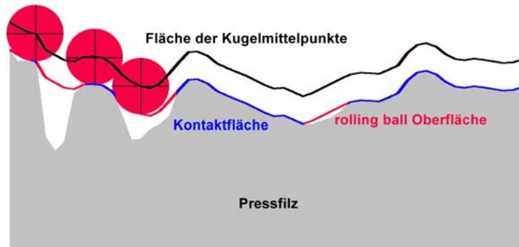
Abbildung 3.7.: Eine virtuelle Kugel rollt über die Filzoberfläche. Die um den Radius der Kugel nach unten verschobene Fläche der Kugelmittelpunkte entspricht der Rolling-Ball / Papieroberfläche (rot). Der Kontaktanteil mit der Filztopographie ist in blau eingezeichnet.
