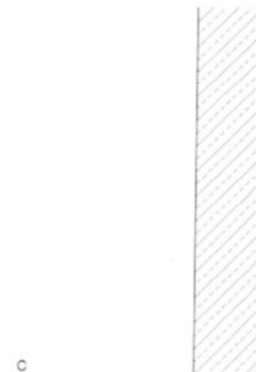
einschalig • einschichtig • opak Wand aus Stahlbeton
