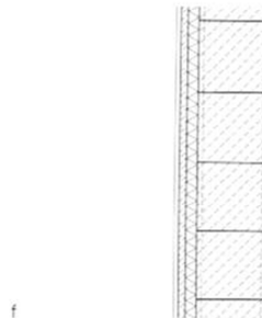
einschalig • mehrschichtig • opak Wandaufbau: Holzfaserzementplatten Wärmedämmung Betonsteinmauerwerk
