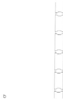
einschalig • einschichtig • transluzent Wand aus Gussglassteine
