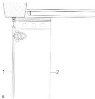
einschalig • einschichtig • transparent 1 ESG 2 Glasschwert ESG
