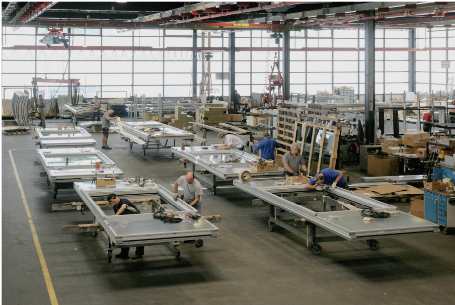
Bild 3.10 Komplettierung von Fassadenelementen 170
