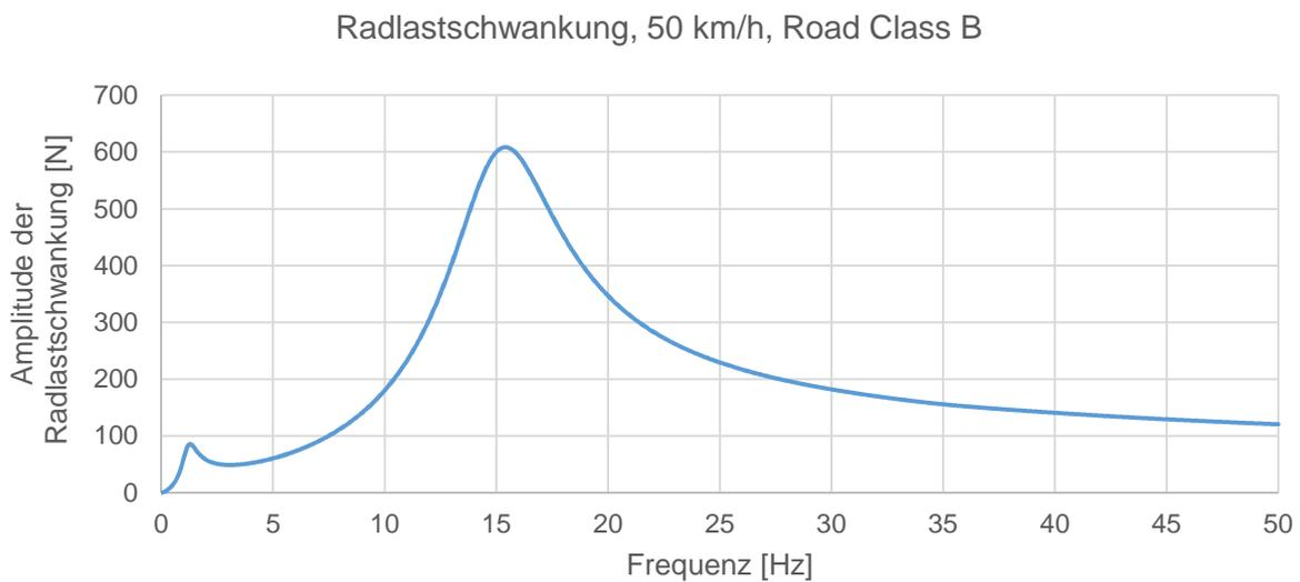
**Abbildung 47: Radlastschwankung von Modell 2**
