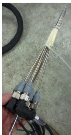
Abbildung 2-29: Kalibrierung von Temperaturfühlern (links: Zusammengebundenes Bündel an Pt 100 Temperatursensoren; rechts: Temperatursensoren im Niedrigtemperaturthermostat)
