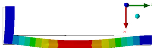
Abbildung 55: Ausbauchen des Isolierrahmens (übertriebene Darstellung)
