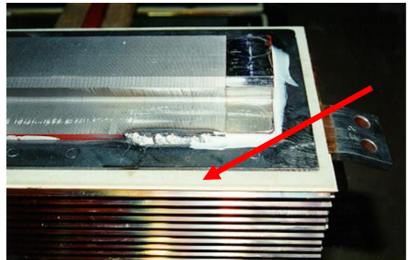
Abbildung 2: Wellenseitiger Isolierrahmen (Andritz)
