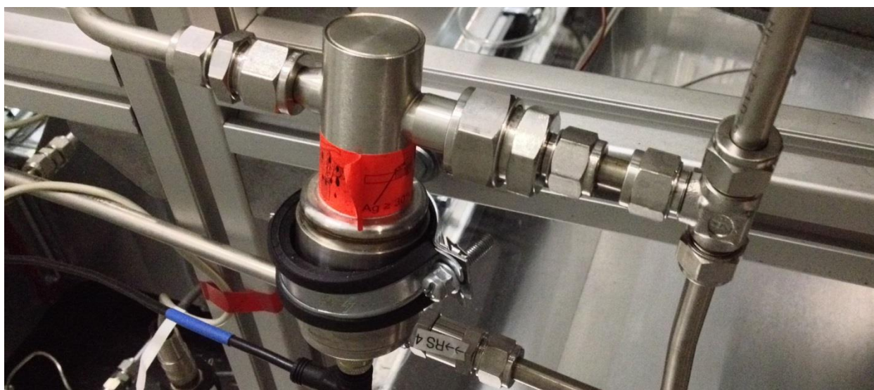
Abbildung 4-12 - EXV1 für die Regelung des Hochdrucks
