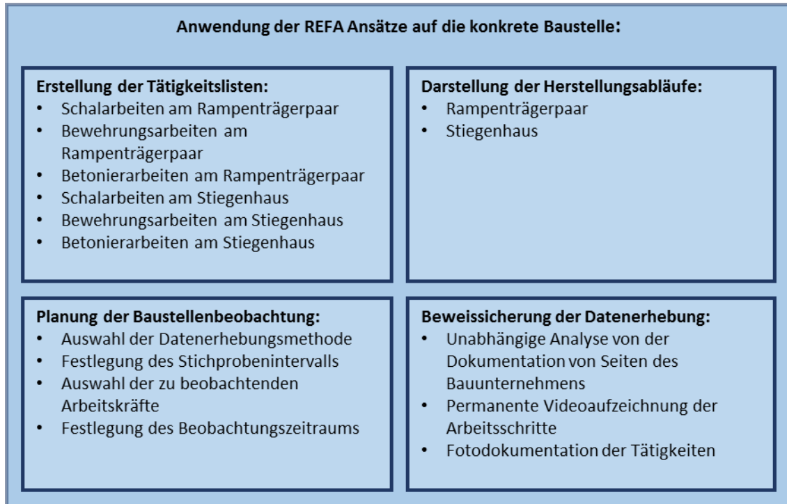
Abbildung 1-6: Detaillierte Darstellung der Anwendung der REFA Ansätze auf die konkrete Baustelle
