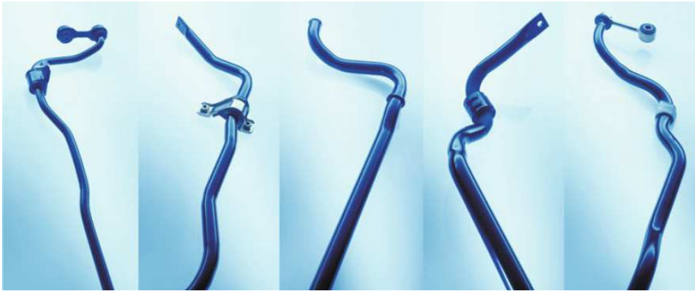
Abbildung 3.11: Beispiele für komplexe Bauformen von PKW Stabilisatoren, [3]
