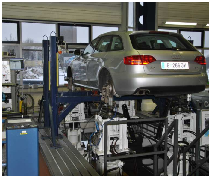
Abbildung 3.6: Achskinematikprüfstand der Forschungsgesellschaft Kraftfahrwesen Aachen, [7]
