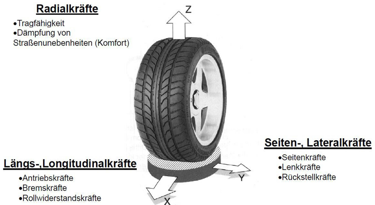
Abbildung 2.8: Reifenkräfte (Mundl, 2013)
