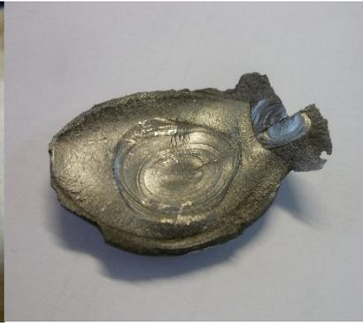
Abb. 10.23: Abgeplatztes Oberflächenelement
