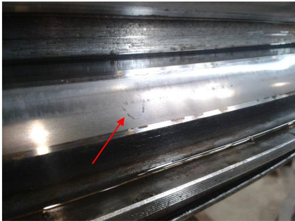
Abb. 10.18: Korrosion entlang der Druckellipse auf Innenlaufbahn
