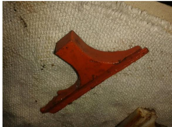
Abb. 10.31: Zerstörung des Käfigs sowie Einlaufen des Käfigs am Grat der Käfig-Führungsnut
