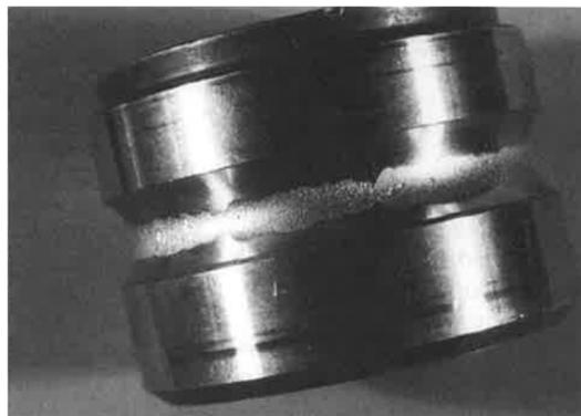
Abb. 10.5: Mikropitting an der Laufbahn eines Rillenkugellagers (Harris et al., 2009, S. 1048)
