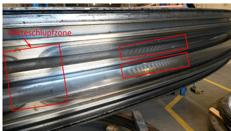
Abb. 10.36: Verschleißmarkierungen durch dynamische Effekte der Kugel im Bereich der Härteschlupfzone des Innenringes
