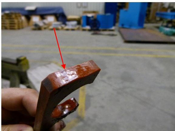
Abb. 10.33: Verschleiß an der Stoßkante des Käfigelementes
