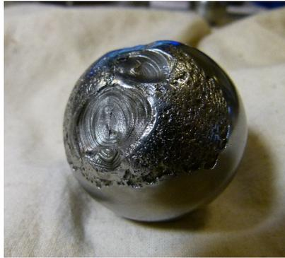
Abb. 10.22: Abplatzungen von der Kugeloberfläche
