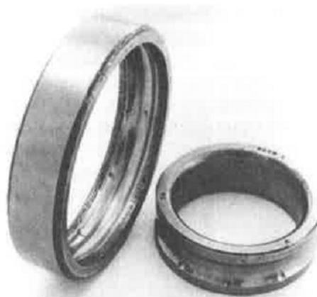
Abb. 10.14: Eindrücke der Wälzkörper in die Schulter des Lagerinnenringes und Lageraußenringes (Brändlein et al., 1995, S. 440)
