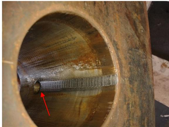
Abb. 10.32: Abscherung eines Grates beim Ausziehen des Stopfens
