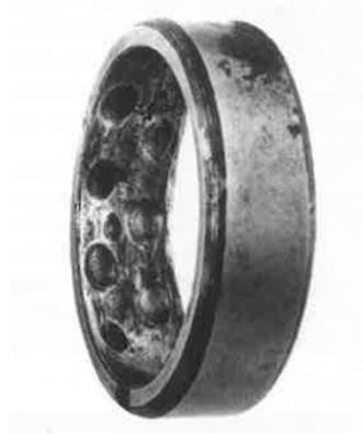
Abb. 10.9: Stillstandmarkierungen eines Pendelrollenlagers durch Schwingungsreibverschleiß (Brändlein et al., 1995, S. 433)
