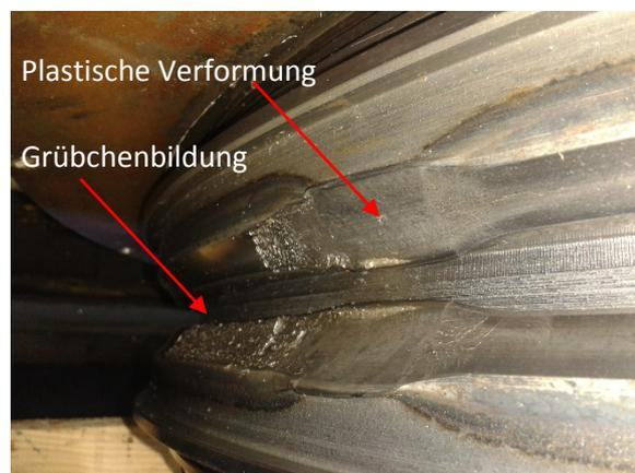
Abb. 10.28: Härteschlupfzone am Innenring mit plastischer Verformung und Grübchen
