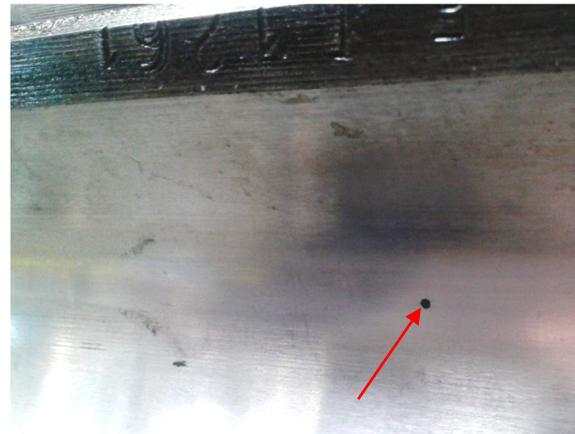
Abb. 10.17: Ausgeprägte Pore am Außenring
