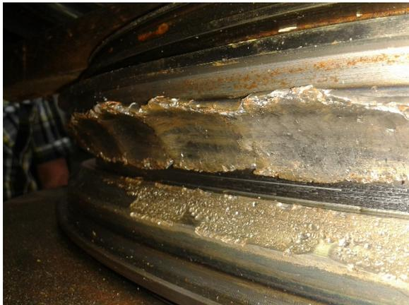
Abb. 10.30: Starke plastische Verformungen an der Laufbahn des Innenringes
