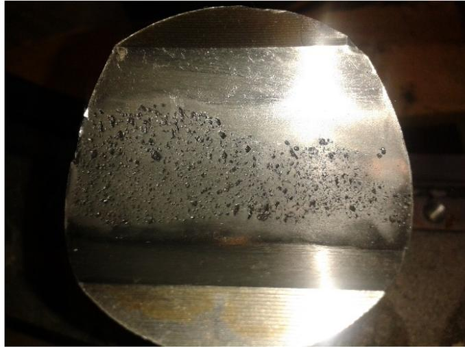
Abb. 10.29: Grübchenbildung am Kugeleinfüllstopfen
