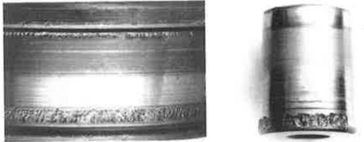
Abb. 10.4: Die verschiedenen Verschleißbereiche eines Linienkontaktes (Brändlein et al., 1995, S. 426)
