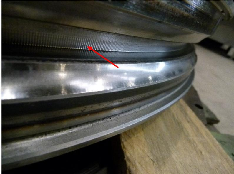
Abb. 10.26: Welligkeit an der Stirnfläche der Käfigführungsnut
