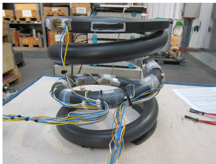
Abbildung 29: Außenfeder mit applizierten DMS 74
