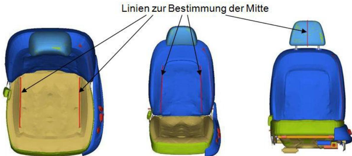
**Abbildung 32: Drei Möglichkeiten zur Bestimmung der Mittellinie des Fahrersitzes für die Strukturbewertung (modifiziert nach [51])**
