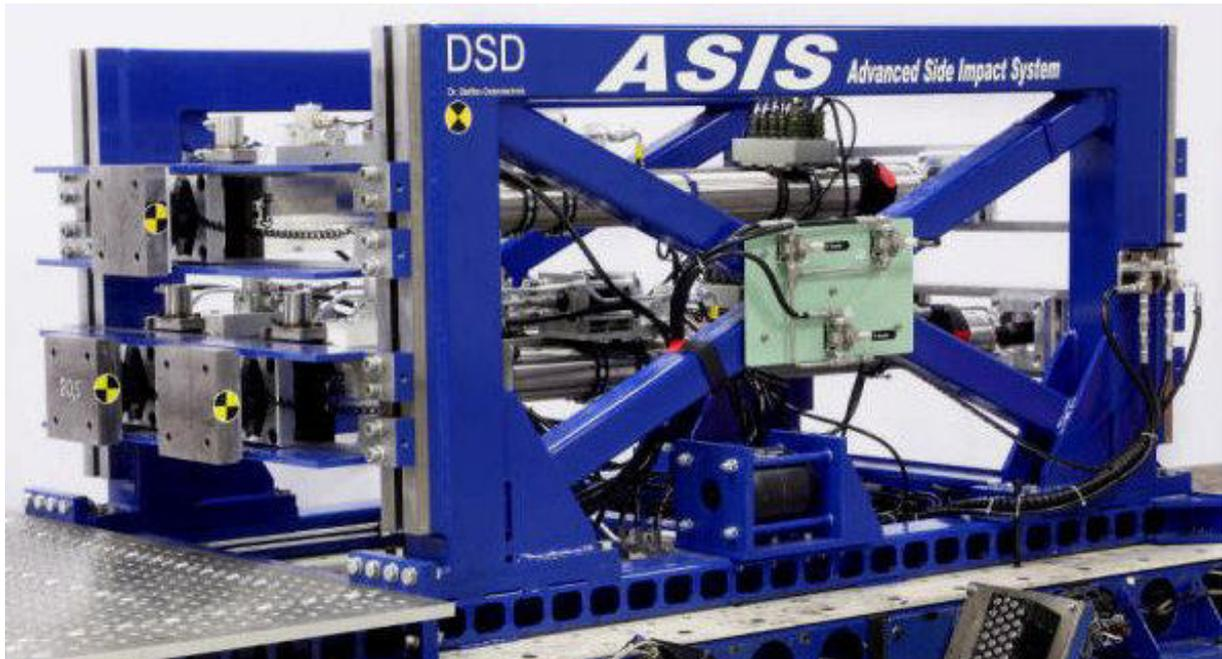
Abbildung 145: Das ASIS mit 3 aufgebauten Intrusionszylinder (vgl. [80])
