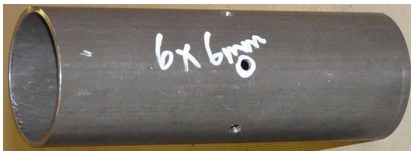
**Abbildung 139: Stauchrohr groß des Versuches 3 mit den Bohrungen am Umfang**
