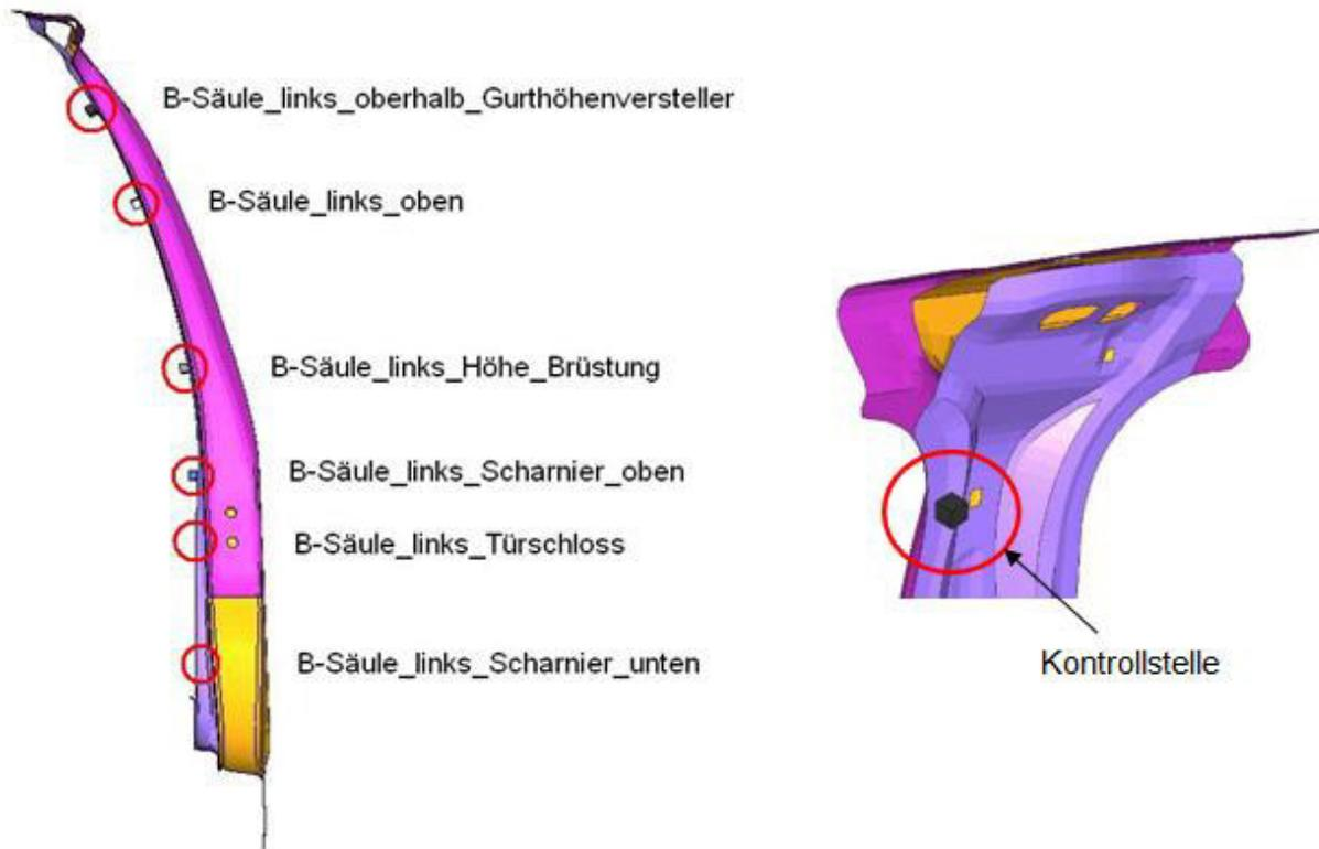
**Abbildung 43: Position der Kontrollstellen für die Ermittlung der Geschwindigkeitsverläufe**
