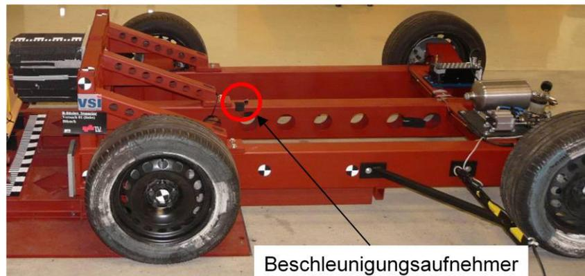
Abbildung 123: Position des Beschleunigungsaufnehmers am Barrierewagen
