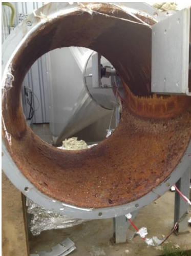
Abbildung 4-6: Dokumentierte Schäden (links: Korrosion der Rohgasleitung; rechts: Beschädigung der Beschichtung im Konus)
