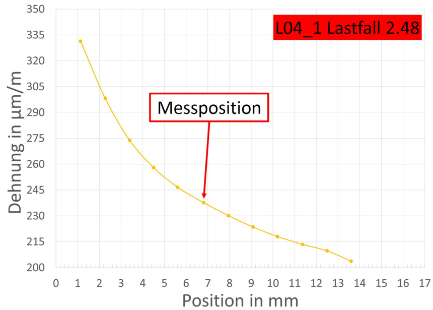
Abbildung 53: Verlauf der Dehnung um Messposition L04-1
