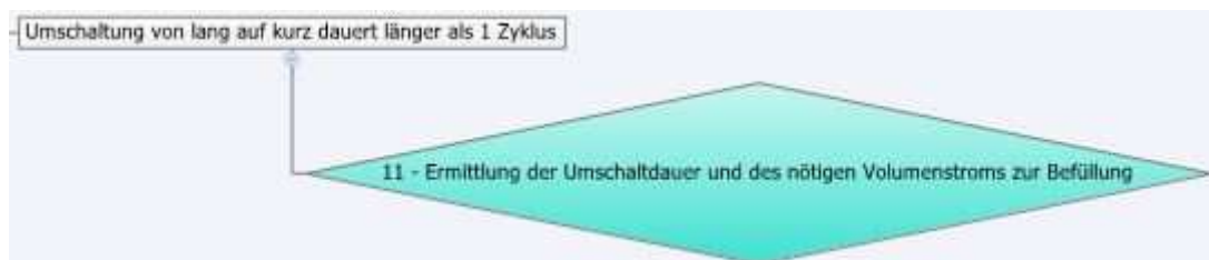
Abbildung 67: Hauptfehler „2 – Pleuel schaltet nicht vom langen in den kurzen Zustand“, Zwischenereignis und Basisfehler / Rechenableitung
