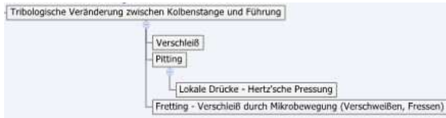
Abbildung 76: Hauptfehler „2 – Pleuel schaltet nicht vom langen in den kurzen Zustand“, Zwischenereignisse und Basisfehler
