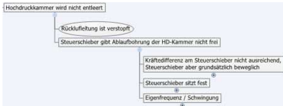
Abbildung 68: Hauptfehler „2 – Pleuel schaltet nicht vom langen in den kurzen Zustand“, Zwischenereignisse
