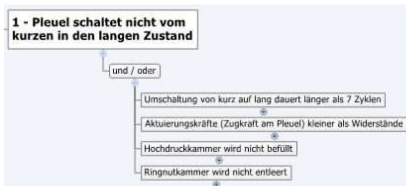
Abbildung 59: Hauptfehler „1 – Pleuel schaltet nicht vom kurzen in den langen Zustand“ mit Zwischenereignissen
