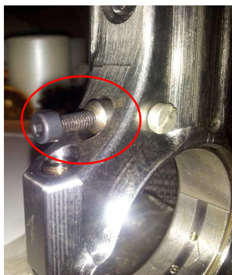
Abbildung 51: VCR - Messpleuel mit verschlossener Rücklaufleitung der Ringnutkammer
