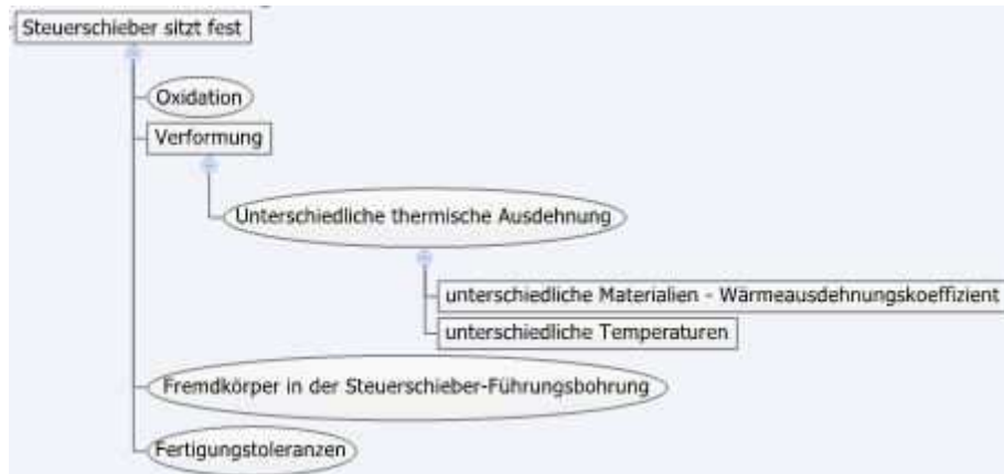
Abbildung 71: Hauptfehler „2 – Pleuel schaltet nicht vom langen in den kurzen Zustand“, Zwischenereignisse und Basisfehler
