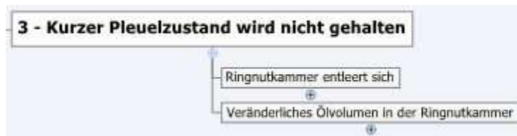
Abbildung 77: Hauptfehler „3 – Kurzer Pleuelzustand wird nicht gehalten“ mit Zwischenereignissen
