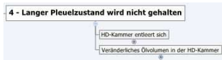
Abbildung 80: Hauptfehler „4 – Langer Pleuelzustand wird nicht gehalten“ mit Zwischenereignissen
