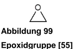
ihren Namen aufgrund der im ungehärteten Zustand vorhandenen Epoxidgruppen (Abbildung 99), die beim Aushärten für die Quervernetzung der Polymerketten verantwortlich ist. Die unterschiedlichen Epoxidharze zählen zu den Duroplasten und
