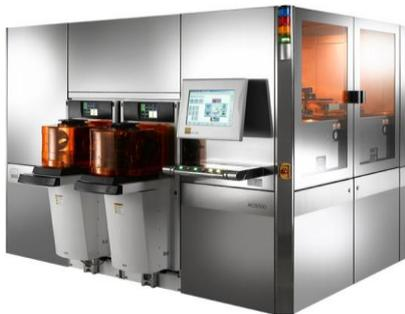
**Abbildung 68 Spray Belacker von Süss MicroTec AG [64]**
