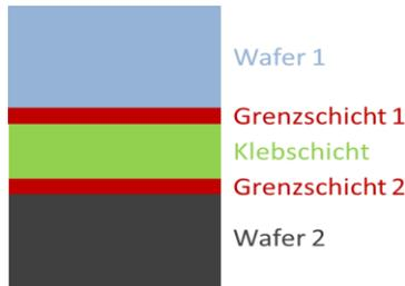
**Abbildung 92 Aufbau einer Adhäsiv Verbindung [49]**
