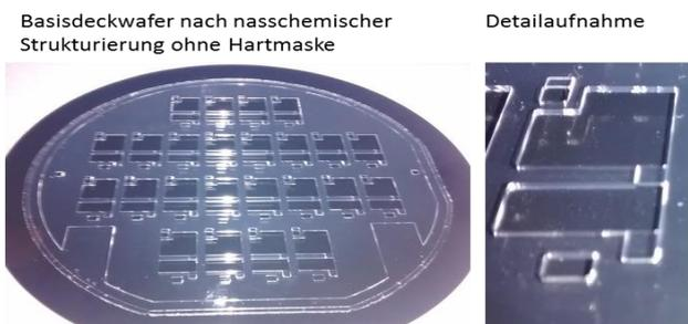
**Abbildung 47 Basisdeckwafer nach nasschemischer Ätzung ohne Hartmaske**
