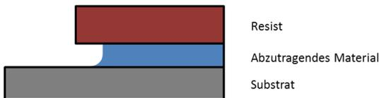
**Abbildung 72 Ätzprofil chemischer Trockenätzprozess [2]**
