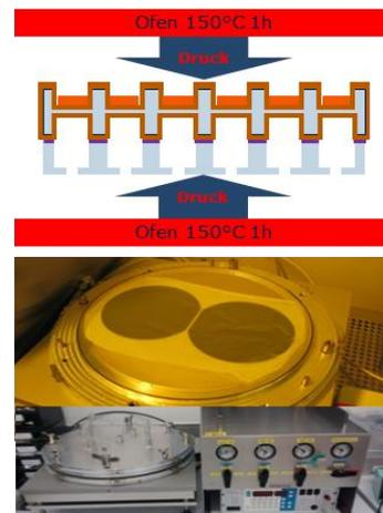
Abbildung 28 Fertigung der Waferverbindung mit Epo-Tek 353ND
