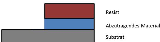
**Abbildung 74 Ätzprofil chemisch physikalischer Trockenätzprozess [2]**
