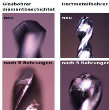
**Abbildung 124 Verschleiß Bohrwerkzeuge nach 5 Glasbohrungen**
