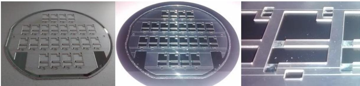
**Abbildung 49 Basisdeckwafer mit Sägestraßen und strukturierter aSi-Schicht**
