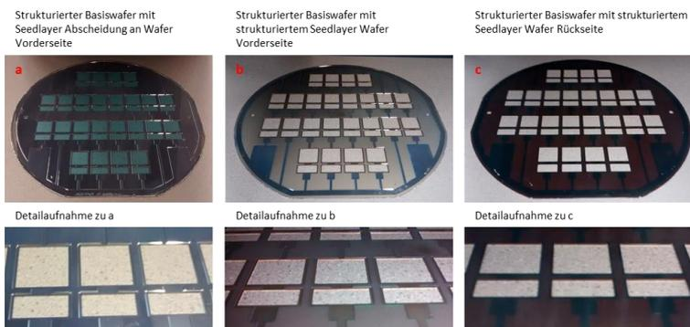
**Abbildung 45 Basiswafer für zweiseitige Kühlung a abgeschiedener Seedlayer, b strukturierter Seedlayer VS, strukturierter Seedlayer RS**
