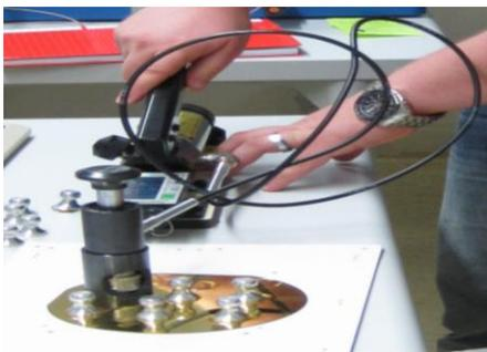
Abbildung 140 pneumatische Prüfvorrichtung zur Haftungsuntersuchung
