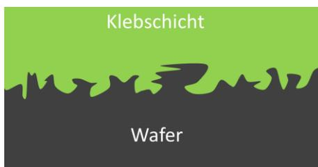
**Abbildung 94 Mechanische Haftung [49]**
