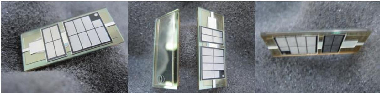
Abbildung 37 Ausgesägte einseitige in Glass gekapselte Leistungshalbleiterkühlsysteme mit eingelöteten Chips
