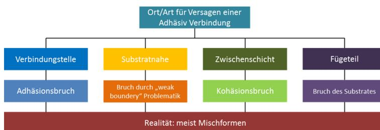
**Abbildung 97 Ort und Art des Bruches einer Adhäsiv Verbindung [53]**
