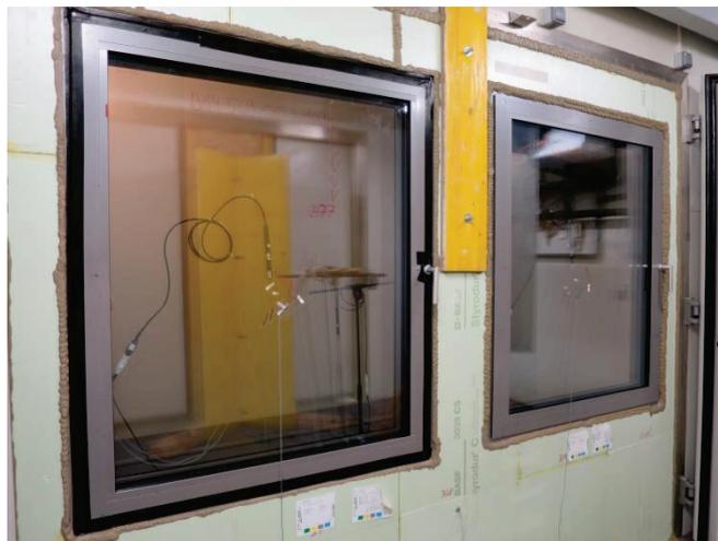
Abb. 29 D-06: F003 (links) Abklebung des Flügelanschlages und F002 (rechts) Originalzustand
