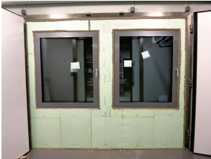
Abb. 12 Doppelklimakammer, Einbau der Maske und der Prüffenster, Ansicht von Innen
