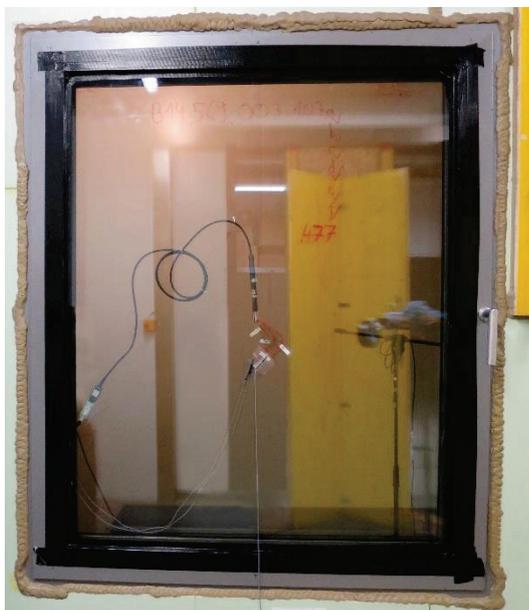
Abb. 25 D-04 (F003): Abklebung der innenseitigen Glasanlagedichtung und Glasleiste
