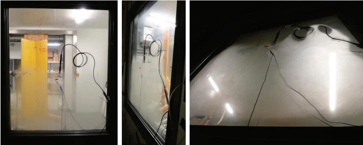
Abb. 23 D-02 (F003): Kondensat Glasposition 2 – Ende der Messung von links nach rechts: Ansicht von vorne, von der Seite und von unten
