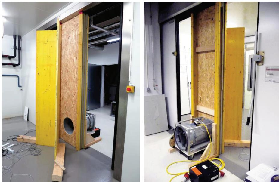
Abb. 11 Ventilator zur Erzeugung eines Überdruckes: Ansicht von Innen (links), Ansicht vom Gang (rechts)
