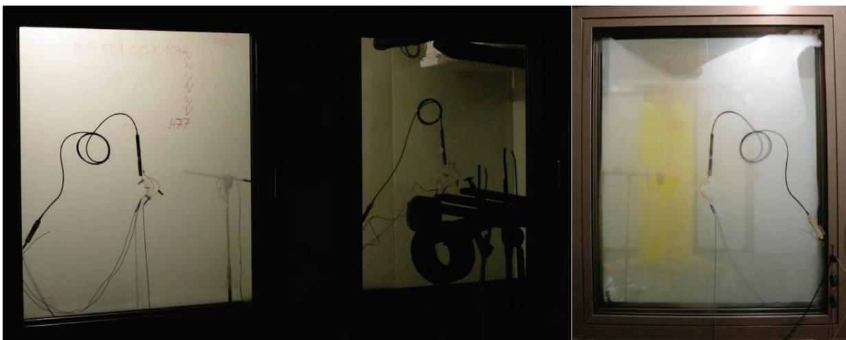
Abb. 27 D-05: Vergleich der Kondensatbildung (Glasposition 2) der beiden Fenster F003 (links) und F002 (rechts)
