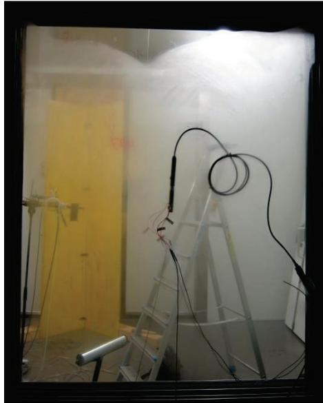
Abb. 22 D-02 (F003): Kondensat Glasposition 2 ca. 20 Min nach Deaktivierung der Außenklimaanlage
