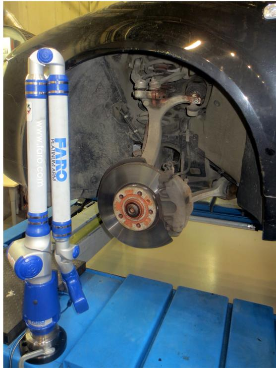
Abbildung 3.19: Mobiles Koordinatenmessgerät für Fahrwerksvermessung
