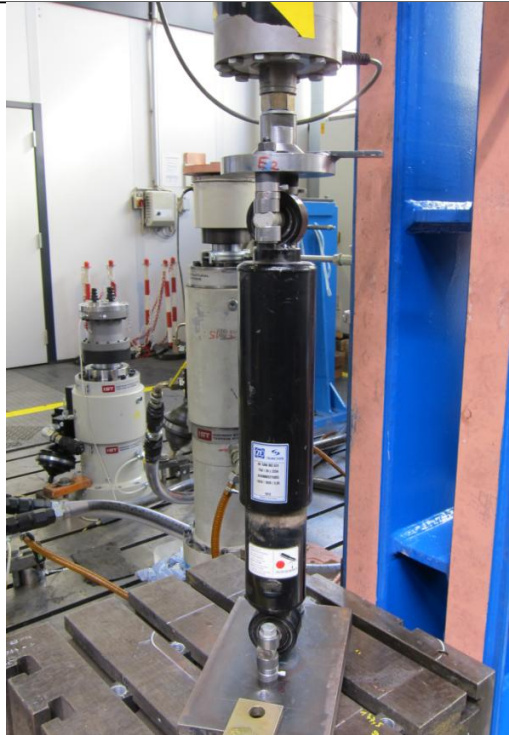
Abbildung 16: Dämpfer des Projektes „1“ während des Prüfvorgangs
