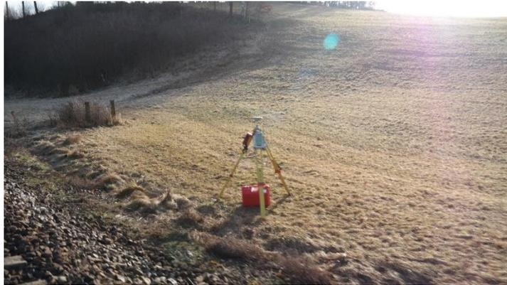
**Abbildung 3 - 18: Basisstation des GPS1200 der Firma Leica**
