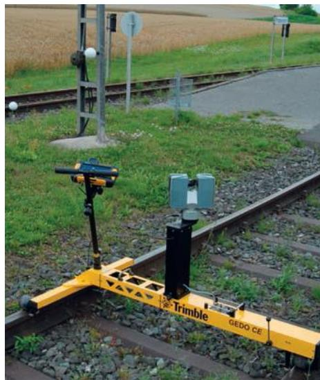
**Abbildung 3 - 2: Gleissmesssystem Trimble Gedo CE 2.0 mit Laserscanner**
