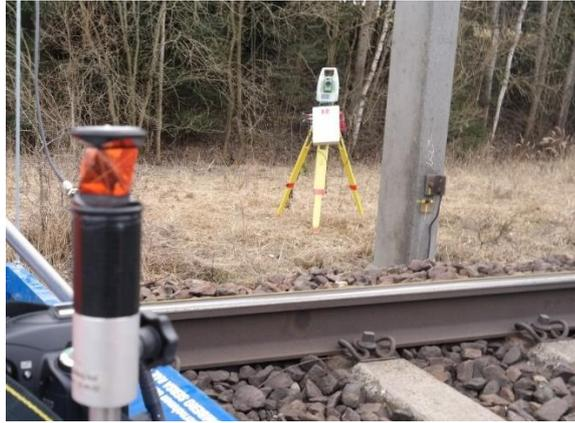
**Abbildung 3 - 19: TS 30 und Leica GRZ101 360° Miniprisma
