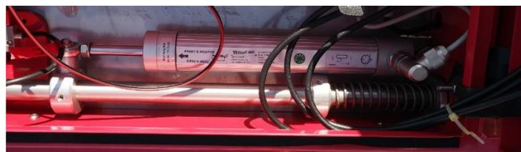
**Abbildung 3 - 11: Linearpotentiometer der Marke Waycon im Testmesswagen**
