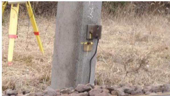
**Abbildung 3 - 1: Vermarktung eines Vermessungspunktes**
