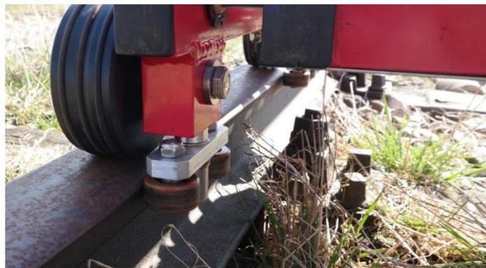
**Abbildung 3 - 7: Radpaare in Schienenkopffinnenseite**
