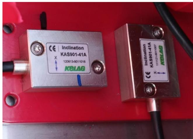
**Abbildung 3 - 17: Die beiden verwendeten Neigungssensoren im Schienenmesswagen**
