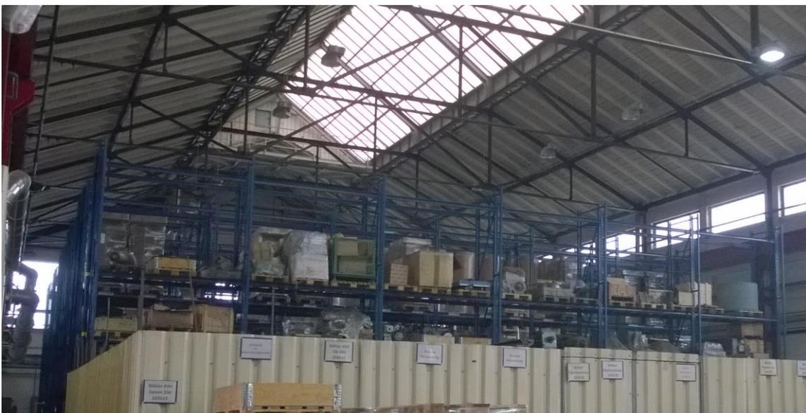
Abbildung 39: Lagerung der Primärverpackung in einem Hochregallager
