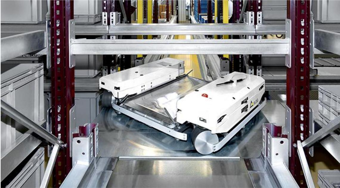
**Abbildung 52: YLOG-Shuttle bei einer 90°-Drehung**
