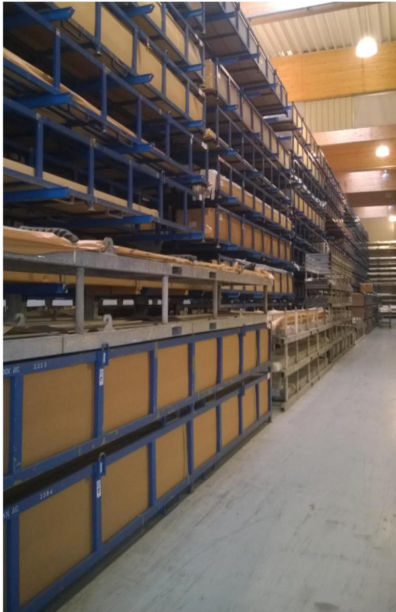
**Abbildung 48: Lagerung der Stangenware in Kragarmregalen**
