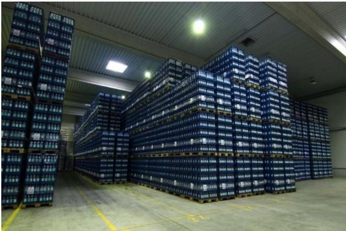
Abbildung 4: Blocklagerung eines Getränkeherstellers [LEH15]
