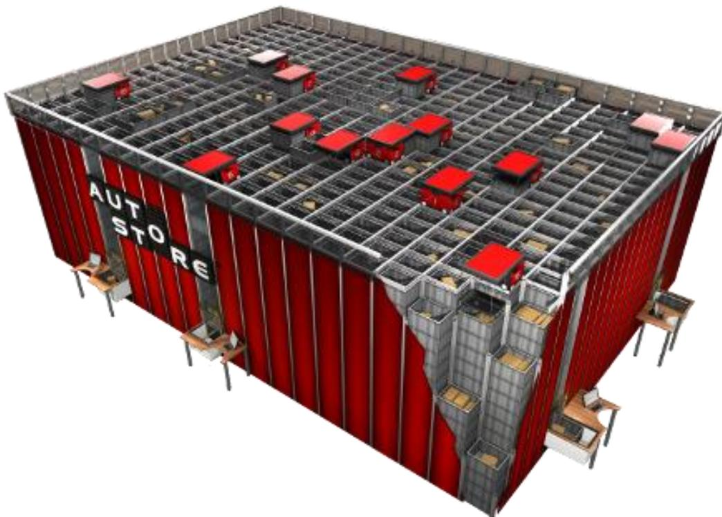
Abbildung 62: Aufbau einer Austostore Anlage ([AML15])
