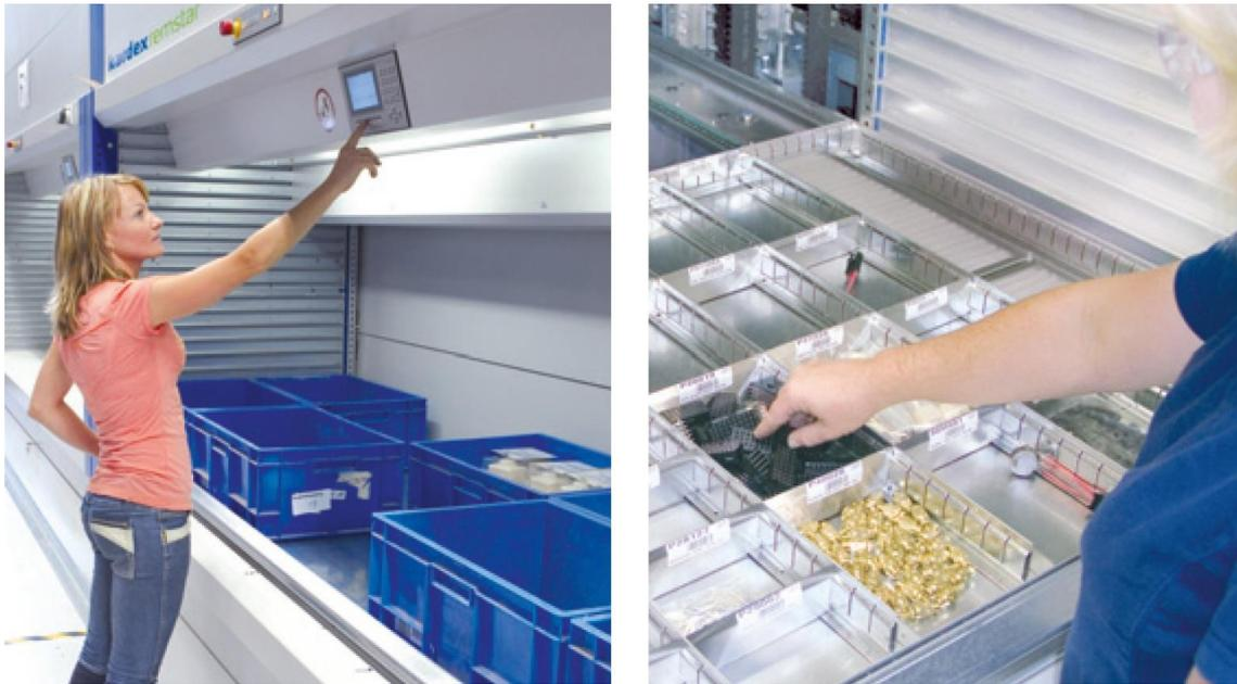
Abbildung 65: Tablare bilden die Basis der Lagereinheiten und können flexibel unterteilt werden (KAR15a], S. 7)
