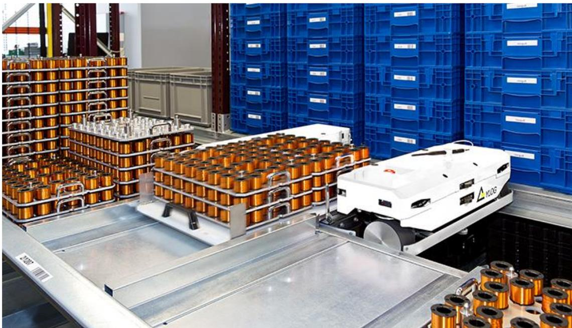
Abbildung 54: YLOG-Shuttle bei der Aufnahme eines Ladungsträgers [YLO15]
