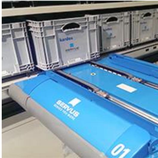
Abbildung 58: ARC3 mit dem Lastaufnahmemittel Smartloader [SER15]
