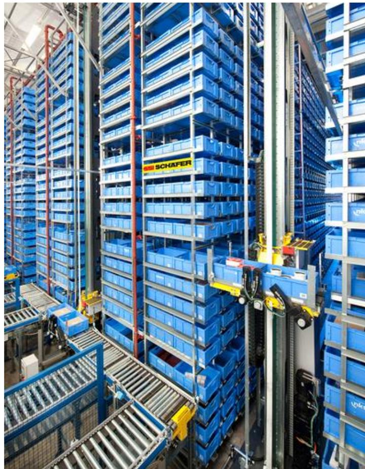
Abbildung 12: Regalbediengerät entnimmt die Ware aus den Hochregallagern [FRI15]
