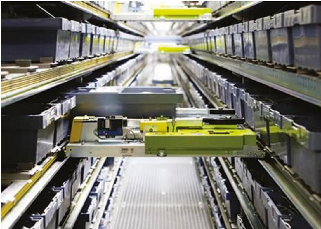
Abbildung 13: Shuttle-System der Firma Knapp [LAG15]
