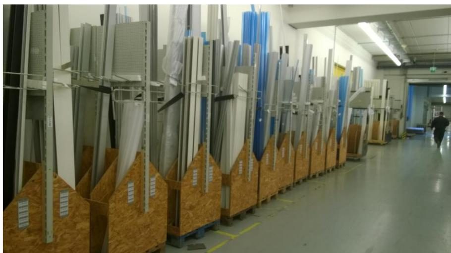
**Abbildung 49: Lagerung von langen Halbfertigfabrikaten**
