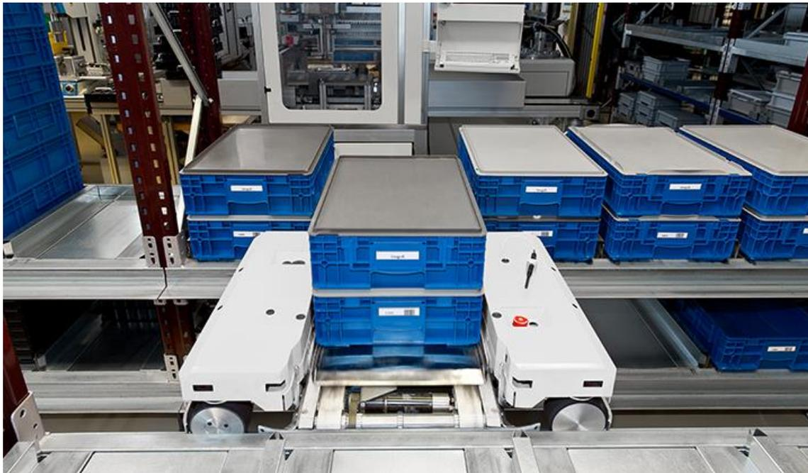
Abbildung 2: Das YLOG-Shuttle bei der Ladungsträgeraufnahme [YLO15]
