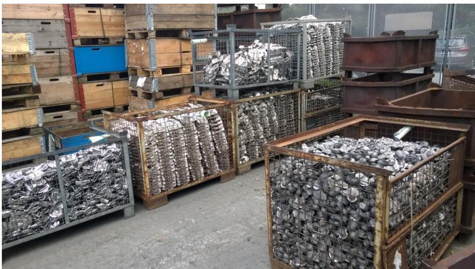
Abbildung 25: Zwischenlagerung der Bauteile zur Abkühlung
