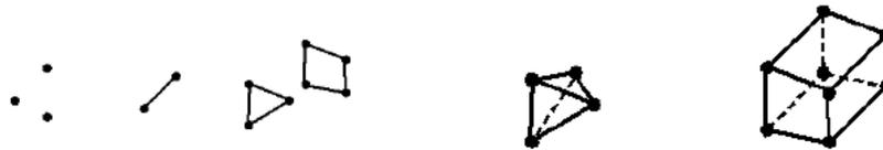
**Abbildung 13 Beginnend von links, Nodes, Beam, Shell-, Tetraeder- und Hexaederelement (Eichberger, 2014)**
