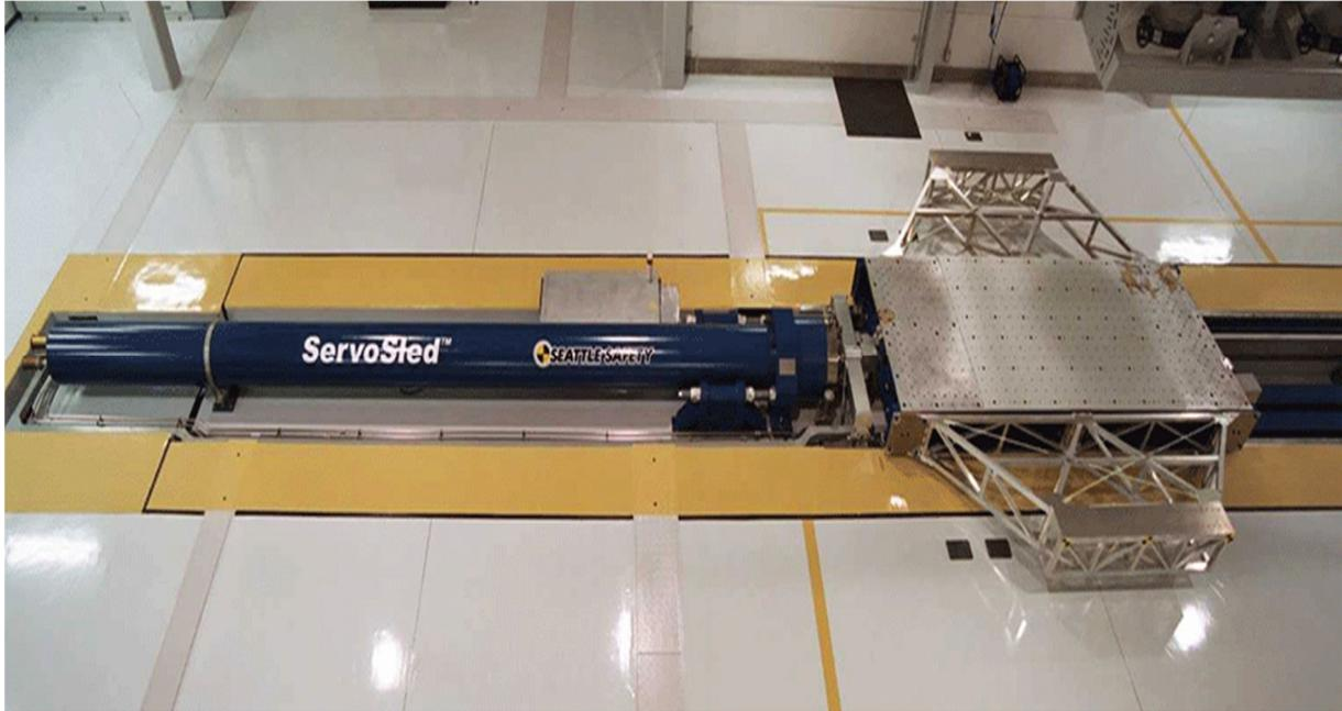
**Abbildung 1 Beschleunigungsschlittenanlage mit Zylinder und Schlitten mit Kamerarahmen (Seattle Safety, 2016)**
