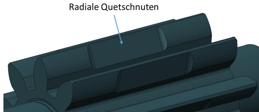
Abbildung 4-22 Radiale Quetschnuten, Quelle: Eigene Darstellung.
