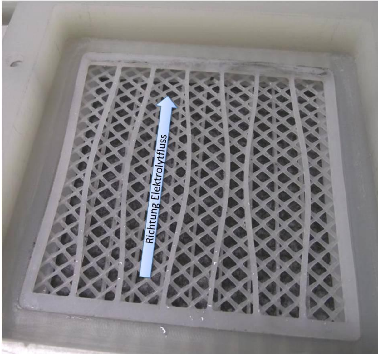
Abbildung 29: Turbulenzpromotor Typ B in der Zelle: Polypropylen-Gitter mit Distanzhalter-Rahmeneinlagen; Die Distanzhalterlamellen lagen auf der Arbeitselektrode und waren in der Richtung des Elektrolytflusses ausgerichtet.
