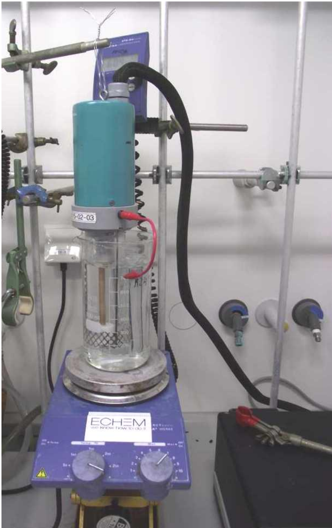
Abbildung 3: Rota-Hull-Zelle, Modell AUTOLAB HT ROTA-HULL (Eco Chemie B.V., Niederlande), mit Steuerungseinheit (rechts unten) und Magnetheizrührer zum Temperieren der Versuche.
