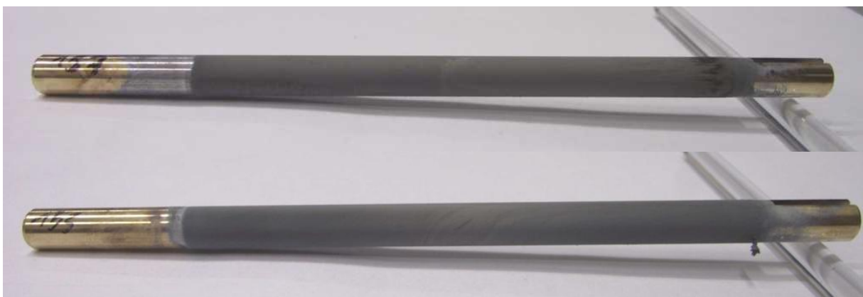
Abbildung 18: Ergebnisse 30-minütiger Zinkabscheidungen bei 60 \text{ }^\circ\text{C} auf Rota-Hull-Zylinderkathoden (Messingsubstrat) aus Elektrolyten mit 7 M NaOH und Zinkkonzentrationen von 0.2 M (oben) und 0.8 M (unten). Die Drehzahl betrug 31 \text{ rpm} ( w = 1.0 \text{ cm s}^{-1} ), die Additivkonzentration (Lugalvan P) betrug 2.4 \text{ g L}^{-1} .
