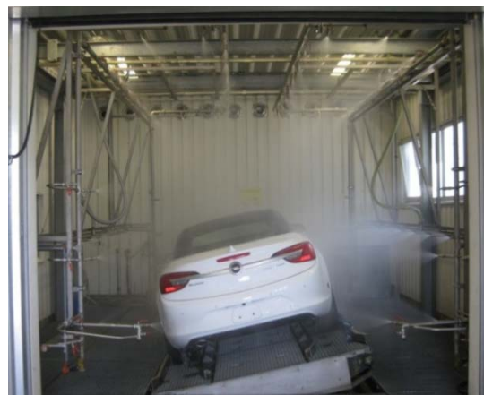
Abbildung 3.15: Simulation eines Regenschauers mit Fahrzeugposition „links seitwärts 6°“ [22]
