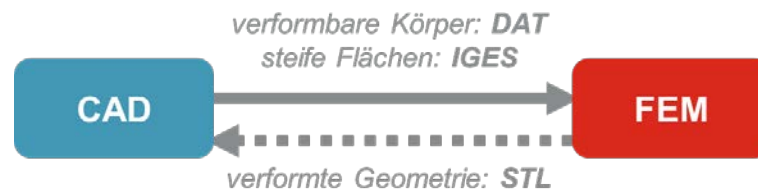
Abbildung 3.40: Verwendete Datenformate beim Datenaustausch der CAD-FEM Prozesskette in dieser Arbeit
