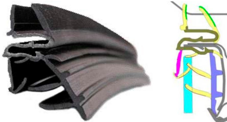
Abbildung 3.10: Fensterführungsdichtung einer Limousine im Bereich Dachrahmen, nach [13]
