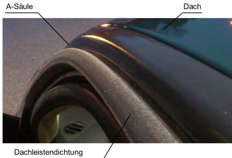
Abbildung 3.7: Dachleistendichtung (VW Golf)
