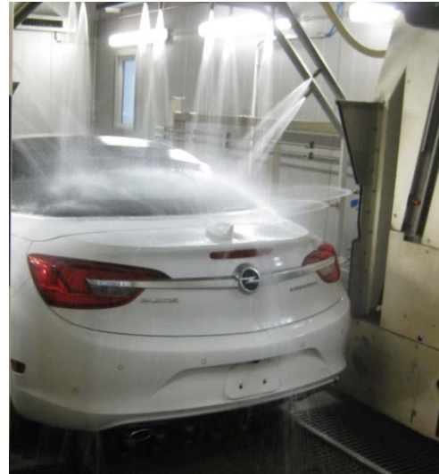
Abbildung 3.18: Autowäsche kontaktfrei – Schwallwasser-Test [22]
