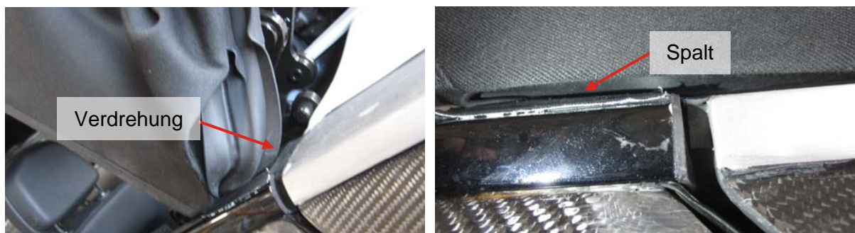
Abbildung 5.35: Ist-Position (Verdrehung des Formteils und Spalt) [41]
