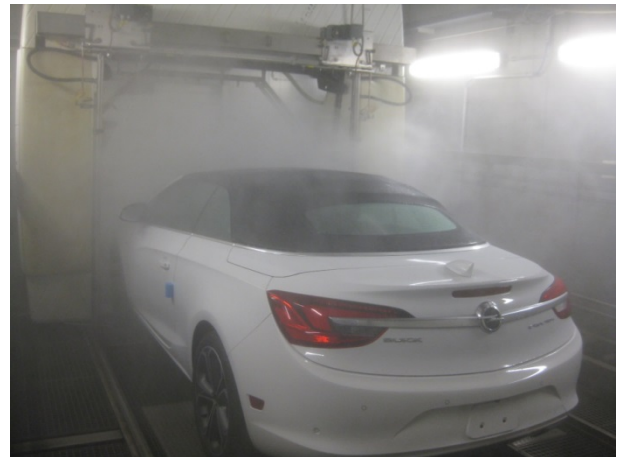
Abbildung 3.17: Autowäsche kontaktfrei – Hochdruck-Test [22]
