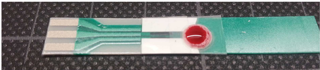
Abbildung 11: Basis Sensor Design mit aufgebautem Mikrokanal aus Tesa Spacer Tape, Tesa hydrophilic Folie, Plasmaseparationsmembran Pall Vivid GR, fixiert mit dem hydrophoben Klebeband Scotch Magic 3M. Der Kanal ist mit reinem Plasma vollgezogen. Dispensiert wurde auf der Membran ein 10 \mu l großer Tropfen Blut aus der Fingerbeere.
