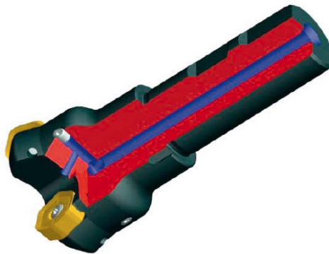
Abbildung 18: Fräser mit innenliegenden Kühlkanälen, Quelle: Heisel, u.a., 2014 S. 433.
