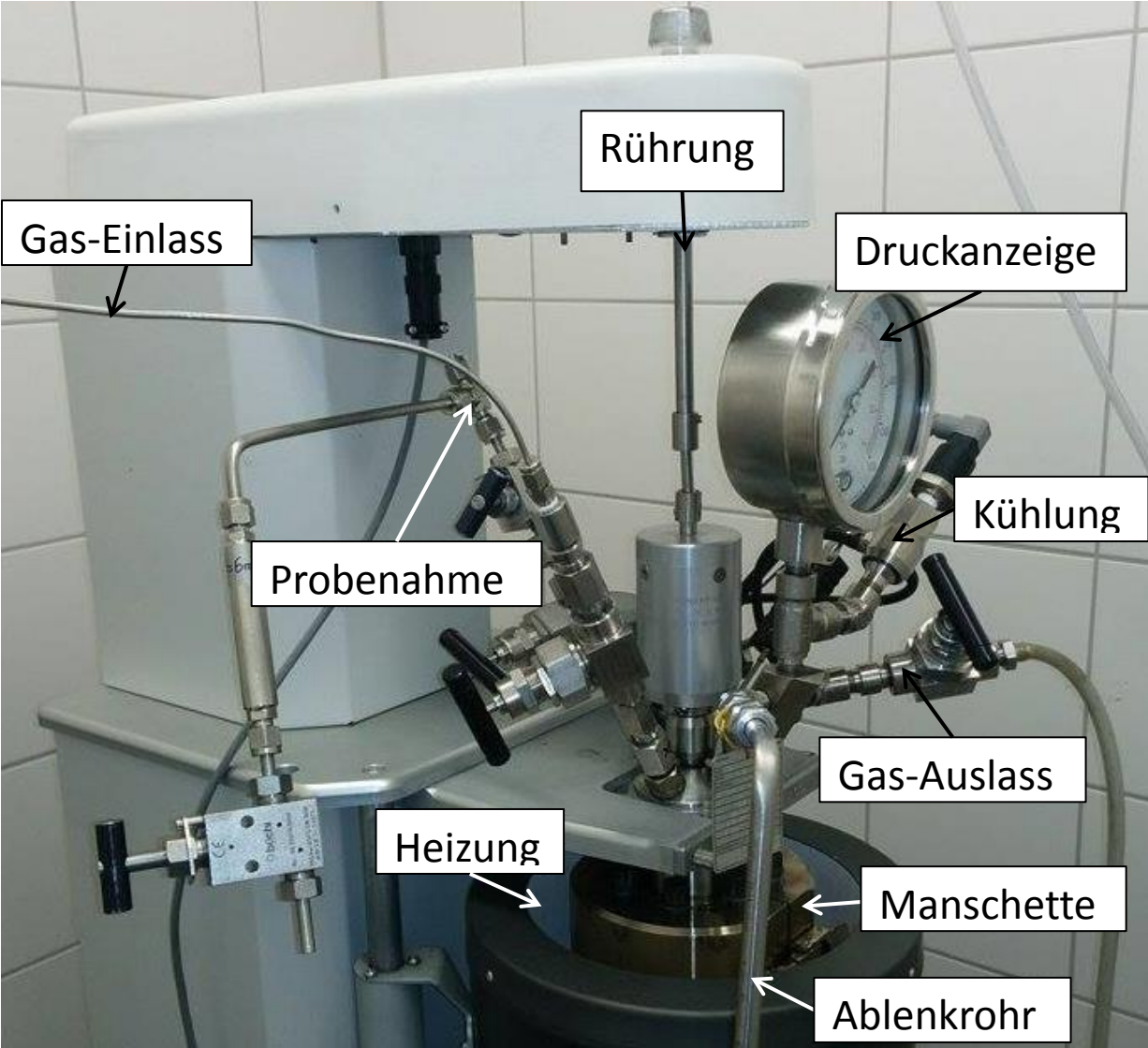
Abbildung 27: Realer Reaktoraufbau (Uni Graz, März 2016)
