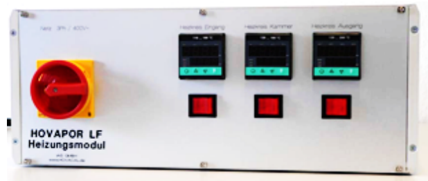
Abbildung 16: Heizungsmodul des HOVAPOR LF 6000 Verdampfers [11]
