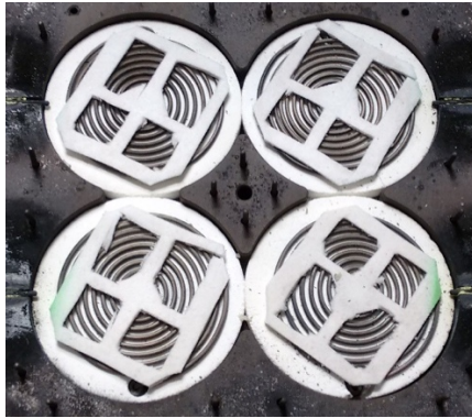
Abbildung 4-23: Einbausituation der Heizelemente [Quelle: AVL]
