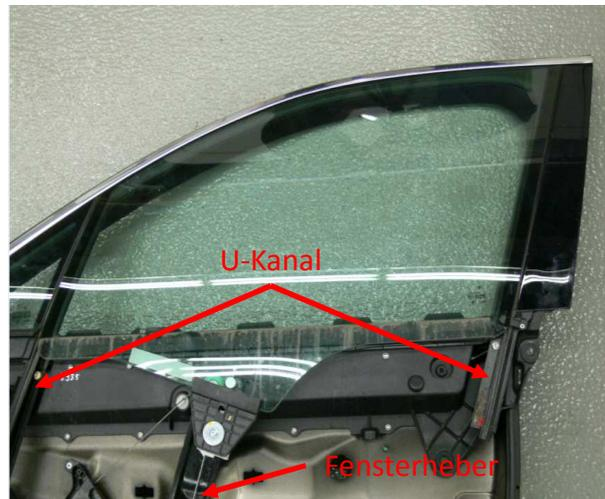
Abbildung 26: Türe vorne mit Fensterheber und Führungssystem
