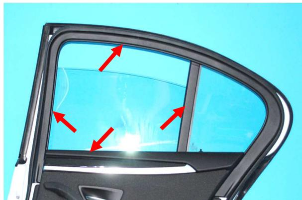
Abbildung 9: Position der Fensterführungsdichtung 523i
