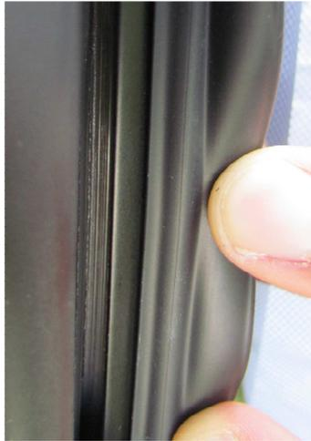
Abbildung 27: Hauptdichtungslippe mit U-Kanal
