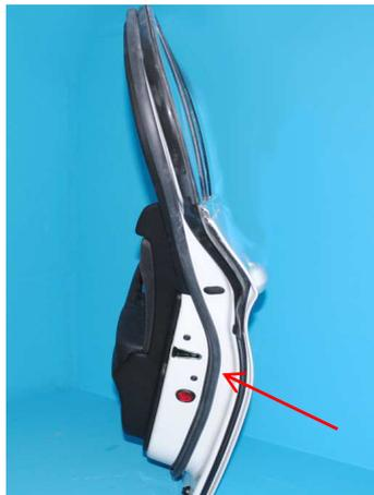
**Abbildung 12: Türhauptdichtung am F10**
