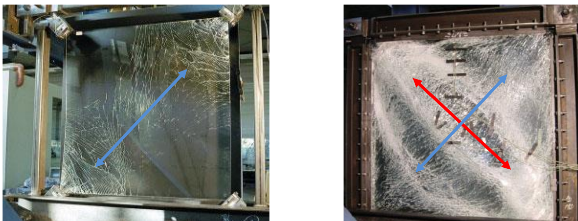
Abb. 23 Bruchverhalten: Eckklotzung (links), Randklebung (rechts) [29]
