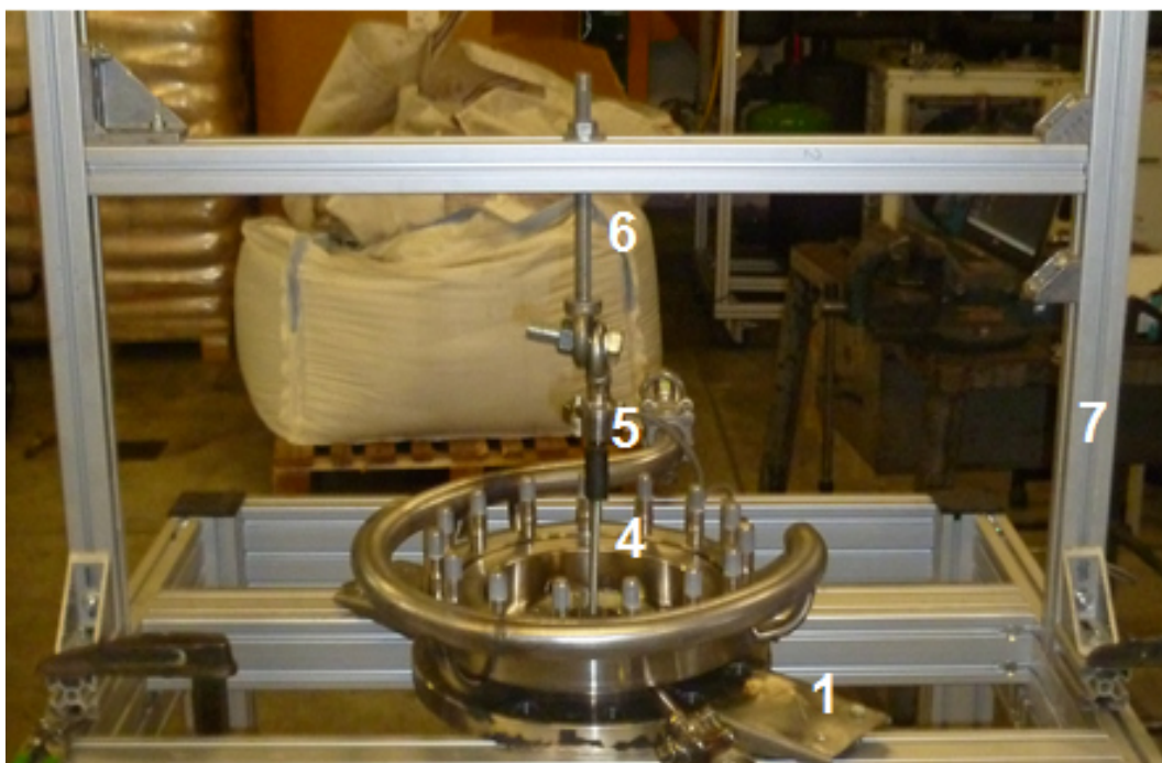
Abbildung 4-12: Messaufbau zur Ermittlung der Membransteifigkeit
