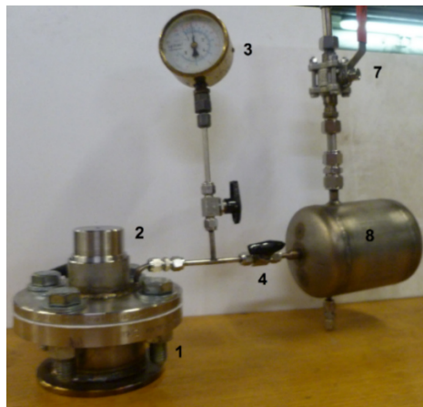
Abbildung 4-5: Messaufbau zur Druckabfallprüfung der Kolbendichtringe mit Wasser/Luft und Kolbenbewegung (Variante 2)
