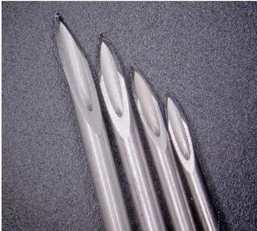
*Abbildung 2-3: Spitzen der verwendeten Kanülen bei 30-facher Vergrößerung:
