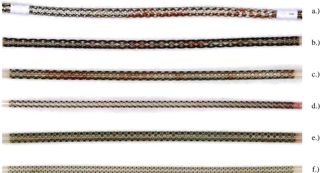
*Abbildung 2-15: Austauschflächen explantierter dOFM-Katheter bei 50-facher Vergrößerung: Braided Standard (a), PEEK Groß 0,5 (b), PEEK Klein 0,5 (c), PEEK Klein 0,36 (d), PEEK Mikro 0,5 (e), PEEK Mikro 0,36 (f)*
