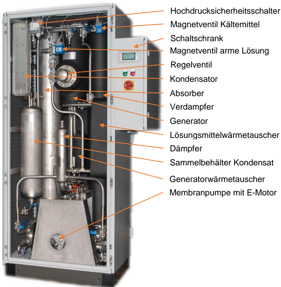
Abbildung 3-1: Pinkchiller PC19 (Quelle: http://www.pink.co.at/thermische-kaeltemaschinen.htm , Stand 03.09.2016)
