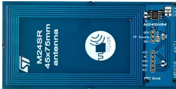
Abbildung 2.4.: M24SR64-Chip mit Platine [31]
