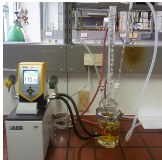
**Abb. 6-13:** Versuchsapparatur mit 2 Proben 1.4571 Stahl bei Versuchsbeginn
