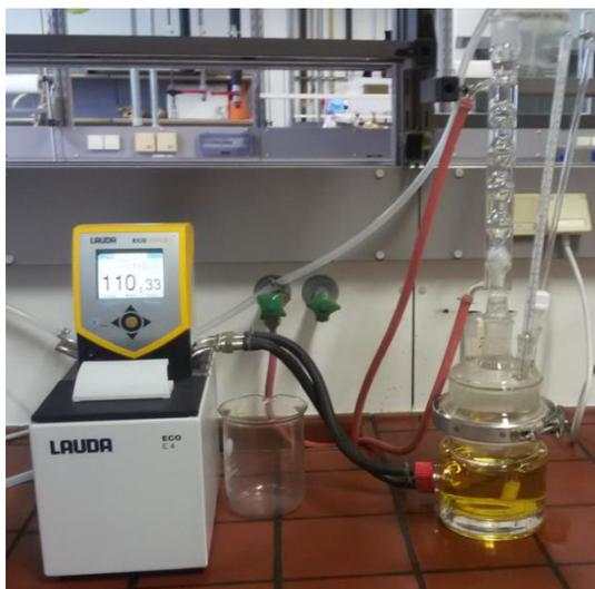
**Abb. 6-12:** Versuchsapparatur mit 2 Proben St37 Stahl und 2 Proben mit 1.7380 Stahl bei Versuchsbeginn
