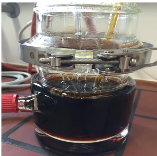
**Abb. 6-14:** Versuchsapparatur mit 2 Proben St37 Stahl und 2 Proben mit Stahl 1.7380 bei Ende des Versuchs
