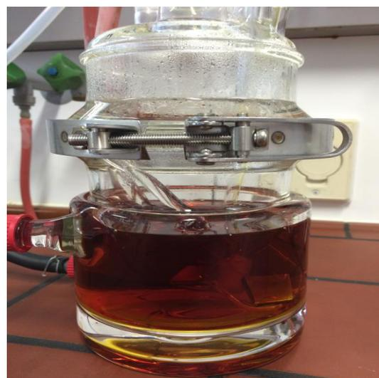
**Abb. 6-15:** Versuchsapparatur mit 2 Proben 1.4571 Stahl bei Ende des Versuchs
