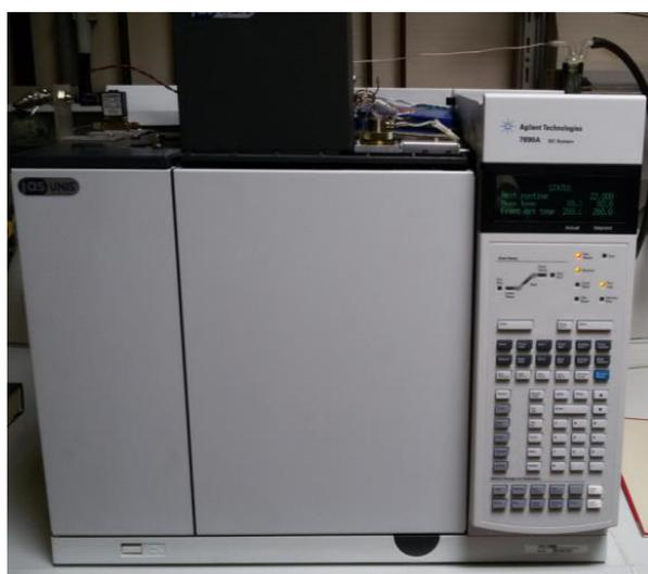
**Abb. 5-1:** GC Messgerät für die Analysen der Gaskomponenten im Prozessgas
