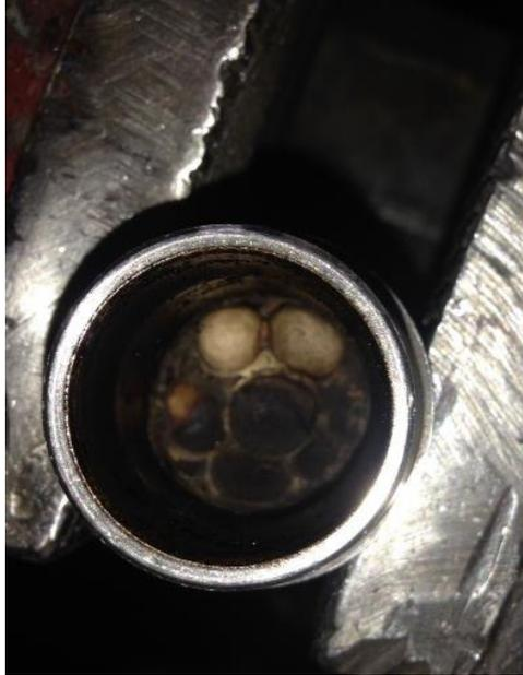
**Abb. 7-34:** Reaktorrohr oben mit verkokten Kugeln von Vogelperspektive
