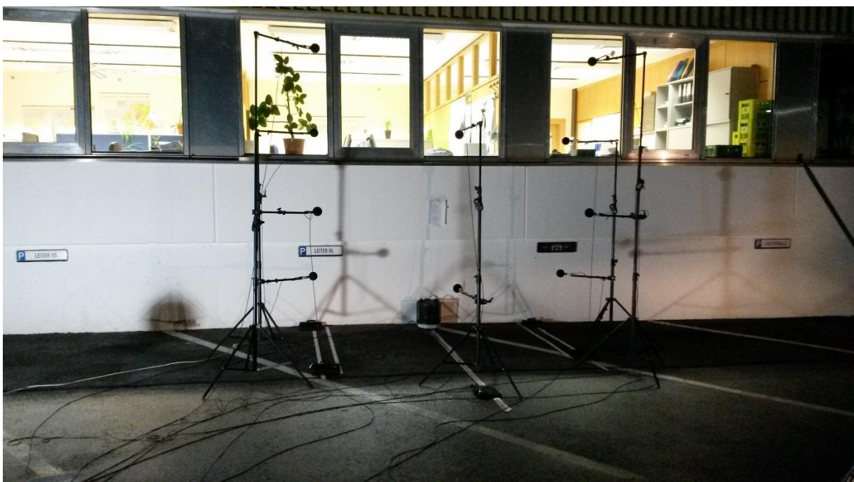
Abb. 5.35: Messaufbau für die 10-Mikrofonmessung (größte Hüllfläche)
