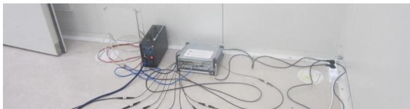
Abb. 5.9 FrontEnd PAK mobile MKII und Norsonic Messverstärker für den Dodekaederlautsprecher
