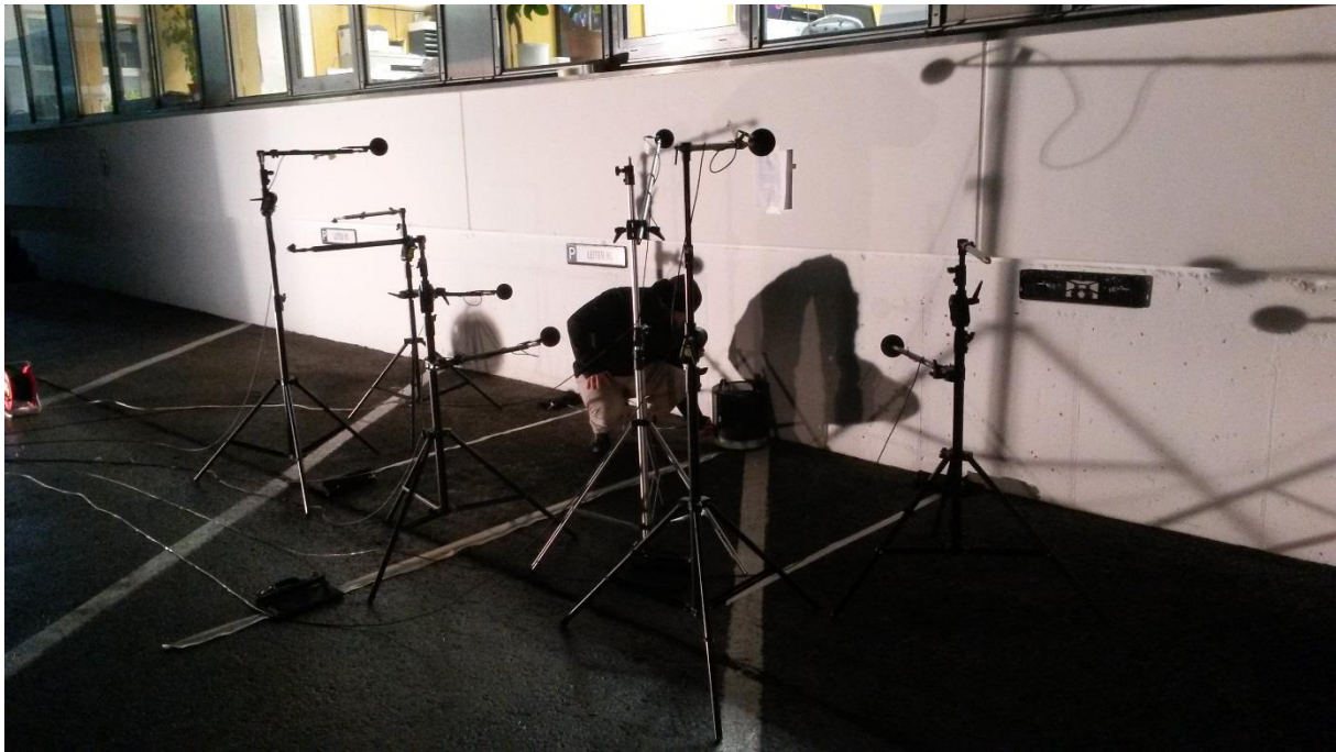
Abb. 5.34: Messaufbau für die 6-Mikrofonmessung (kleinste Hüllfläche)
