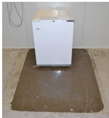
Abb. 2.7: Harzschicht für optimale Reflexion am Aufstellungsort
