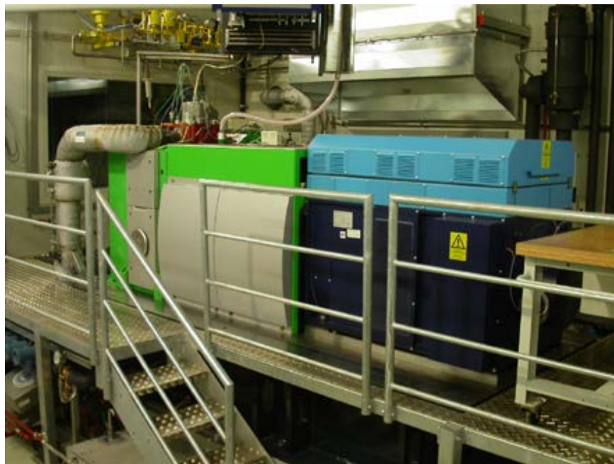
Abbildung 1.2: Einzylinder-Forschungsmotor an der LEC GmbH (Quelle: WIMMER (2014), Kapitel 4: Seite 7)
