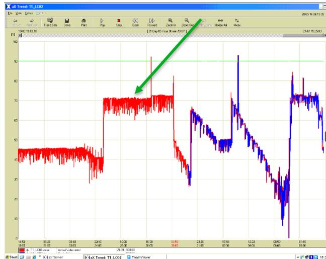
Abbildung 8: Screenshot Druckverlauf im Hydrolysebehälter T1: Der konstante Druckverlauf (grüner Pfeil) weist auf eine Verstopfung in der Rohrleitung hin.
