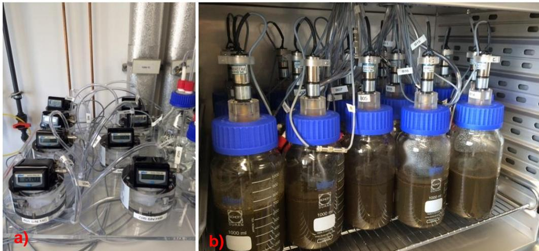
**Abbildung 1:** Versuchsaufbau Batch-Versuch der Fa. „Ritter“: a) Milligascounter mit Gasschläuchen; b) Gasflaschen mit integrierten Rührer.
