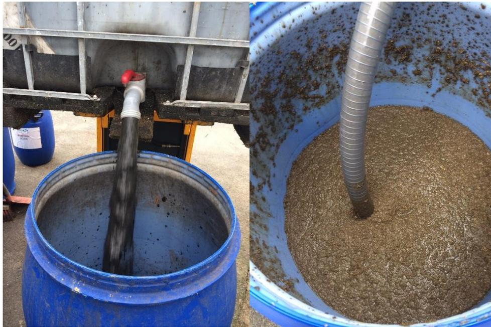
Abbildung 7: Anmischen des Inoculums mit Treber (links) und anschließende Fütterung in die Hydrolysebehälter (rechts).
