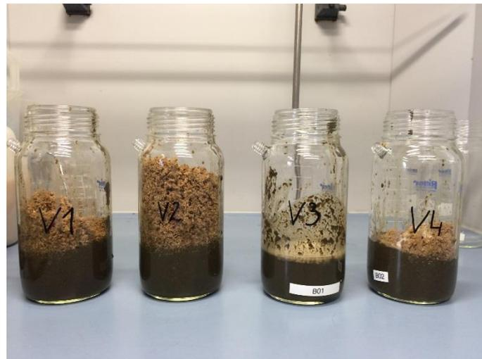
**Abbildung 16: Probenvorbereitung zur Evaluierung der Substrate, V1:Originalmenge Hefe und Treber; V2: doppelte Menge Treber, keine Hefe; V3: doppelte Menge Hefe, kein Treber; V4: Hälfte an Hefe, Hälfte an Treber.**
