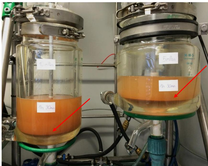
Abbildung 14: Reaktorversuch nach 1,5 Stunden Verweilzeit bei 10 mPas (links) und 5 mPas (rechts).
