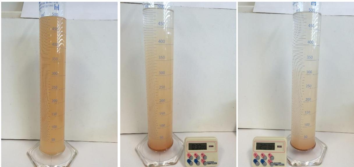
Abbildung 12: Beobachtung des Absinkverhaltens von Kieselgur im Messzylinder, links homogen durchmischte Kieselgur in Wasser; mitte: Messzylinder nach 30 min; rechts: Messzylinder nach 2 Stunden.
