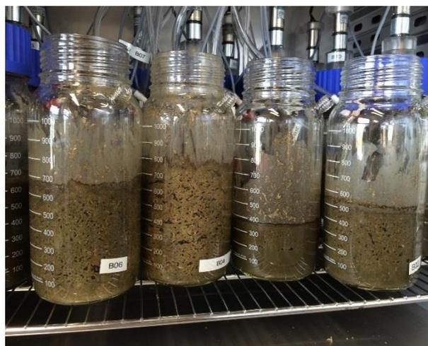
Abbildung 17: Proben nach zwei Stunden Verweilzeit bei 38 °C, von rechts nach links: V1:Originalmenge Hefe und Treber; V2: doppelte Menge Treber, keine Hefe; V3: doppelte Menge Hefe, kein Treber; V4: Hälfte an Hefe, Hälfte an Treber.
