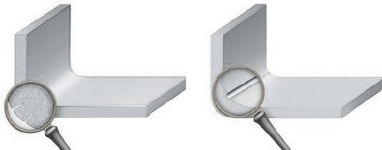
Abbildung 7: Links: Haarrisse an Bauteilaußenseite; Rechts: Quetschfalten an Bauteilinnenseite [Tru96]
