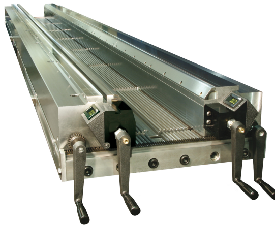
Abbildung 23: Verstellung der Biegebacken mittels Verzahnungen in diskreten Abstufungen [Acc16]
