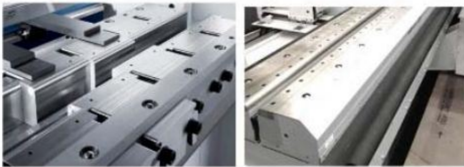
Abbildung 20: Werkzeuge von EHT - links: EHT Vario manuell Tool; rechts: EHT Vario CNC Tool [Tru16]
