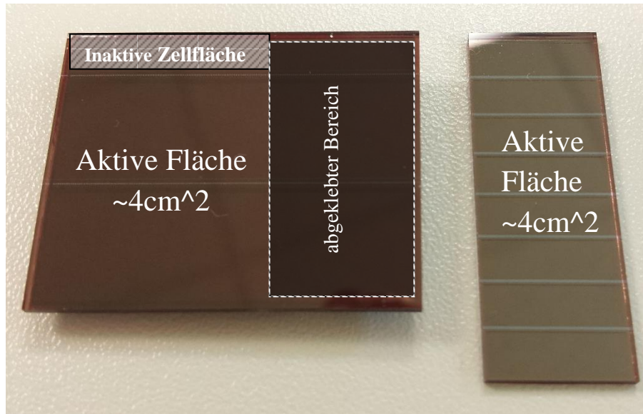
Abbildung 15: 2 Zellige Budasol ASI10i02 (links); 8 zellige Trony ECS100 (rechts)
