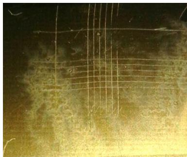
**Abbildung 4-36:** Foto eines mit Gold beschichteten FR4 Substrats, das wiederum per Spincoating mit einem Negativlack der Zusammenstellung pNonOx<sub>80</sub>-stat-pDc=Ox<sub>20</sub> + 4SH beschichtet wurde.
